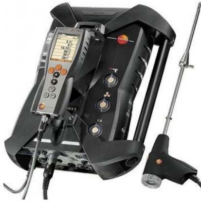
รูปที่ 33 เครื่องวัดประสิทธิภาพการเผาไหม้และถ่ายมลพิษจากปล่องระบายน
