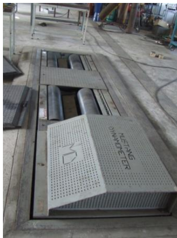
รูปที่ 13 เครื่องวิเคราะห์สภาพรถยนต์แบบแซสซิสไดนาโมมิเตอร์
