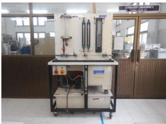
ชุดทดลองความเสียหายการไหลของน้ำ แบบราบเรียบและแบบปั่นป่วนในท่อ
