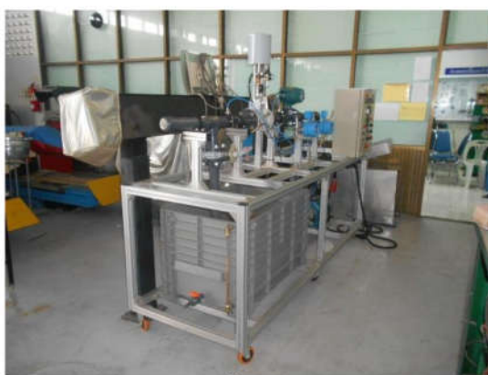
ชุดทดลองเครื่องสูบน้ำ วาล์ว ข้อต่อและข้องอ
