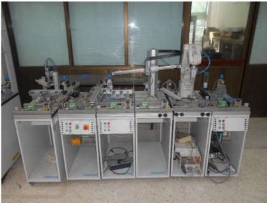
ชุดทดลองการแยกวัสดุ การย้ายวัสดุ และการจับวางวัสดุอัตโนมัติ
