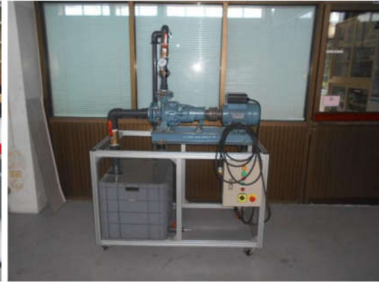
ชุดทดลองการปรับตั้งแนวเส้นตรงศูนย์กลาง ระหว่างเพลาคูร่งสูบน้ำ
