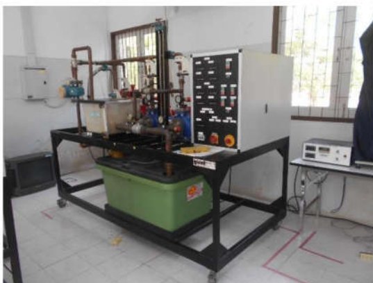
ชุดทดลองเครื่องสูบน้ำการติดตั้ง แบบอนุกรมและแบบขนาน
