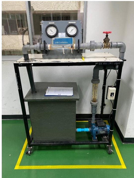
รูปที่ 23 ชุดทดสอบคาวิเตชัน (Cavitation Test Set)
