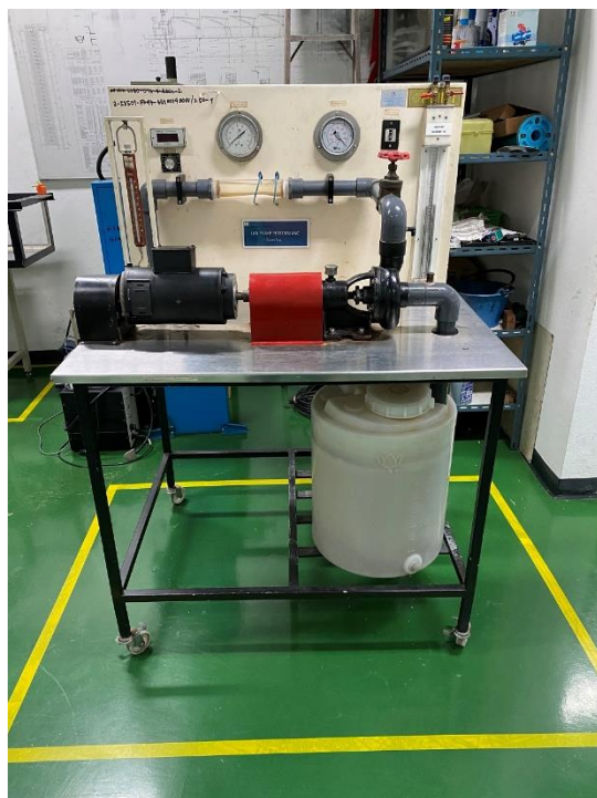
รูปที่ 18 ชุดทดสอบสมรรถนะของเครื่องสูบน้ำแรงเหวี่ยงหนีศูนย์กลาง (Centrifugal Pump Performance Test Set)
