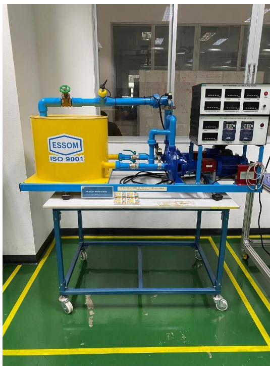
รูปที่ 28 ชุดทดสอบปั้มน้ำแบบขนานและอนุกรม (Compact series and Parallel Pump Test Set)
