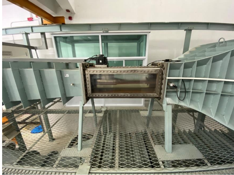
รูปที่ 33 ชุดทดสอบใบจักรเรือ (Propeller Test)
