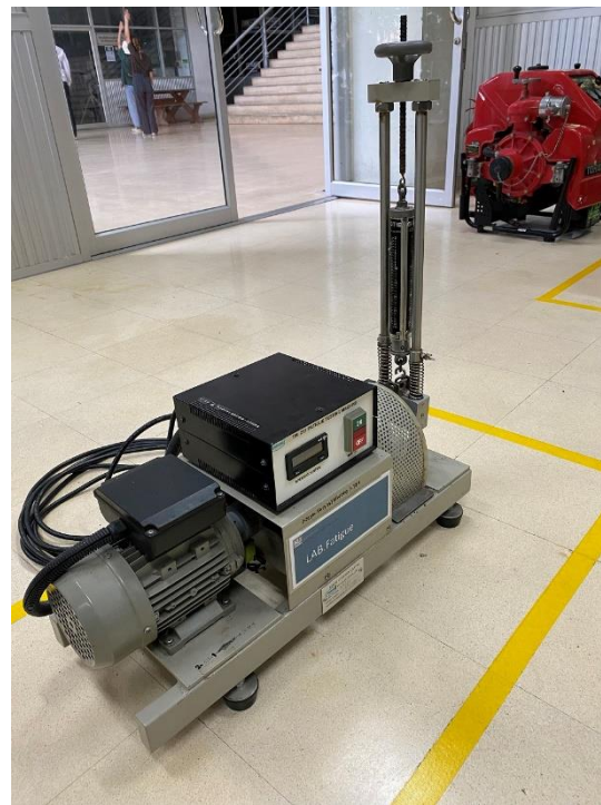
รูปที่ 6 ชุดทดสอบความล้า (Fatigue Test Set)
