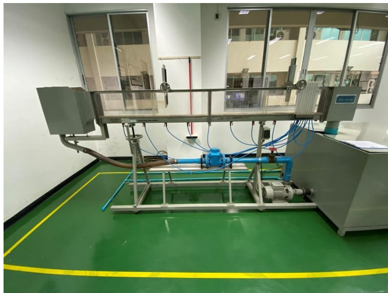
รูปที่ 26 ชุดทดสอบการไหลในรางเปิด (Open Channel Flow Set)
