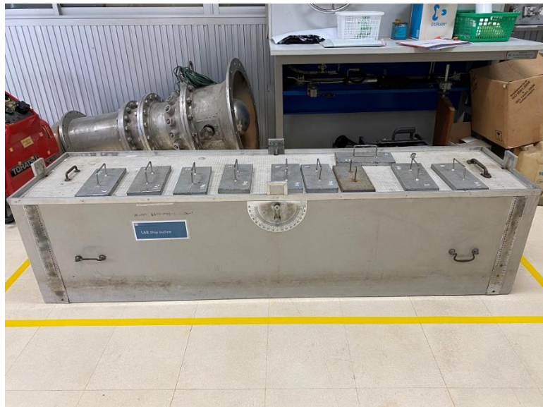
รูปที่ 30.ชุดทดสอบการเอียงเรือ (Ship Incline Test Set)
