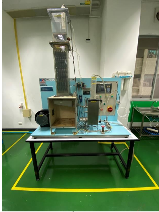
รูปที่ 15 ชุดทดสอบหอผึ่งน้ำ (Cooling Tower Test Unit)
