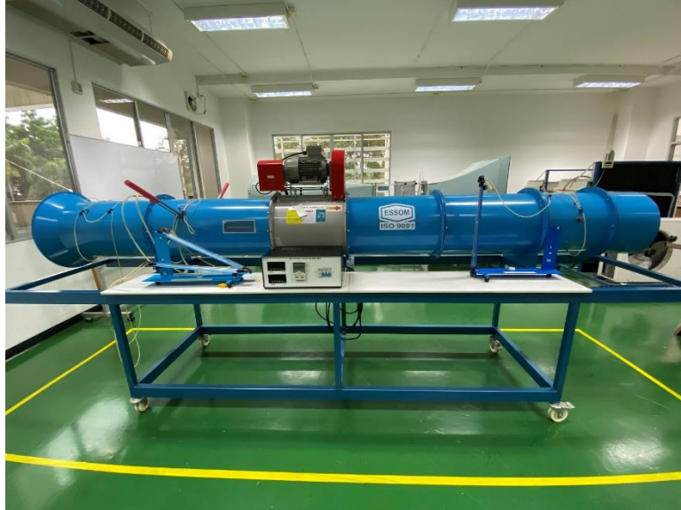
รูปที่ 27 ชุดทดสอบพัดลมแบบไหลตามแนวแกน (MP 124 Axial Flow Fan Test Set)
