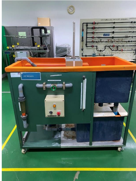
รูปที่ 31 ชุดทดสอบการหาจุดเปลี่ยนศูนย์เสถียร (Metacentric Height Set)
