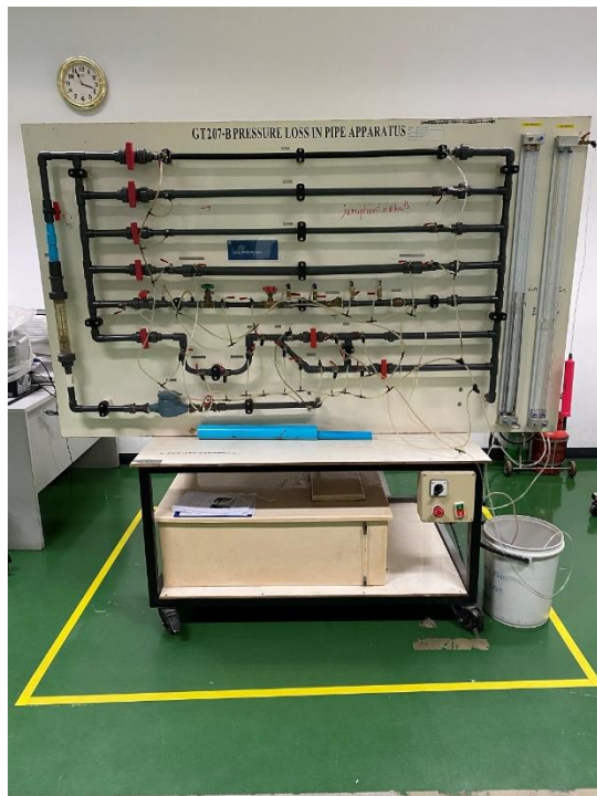
รูปที่ 20 ระบบการสูญเสียความดันภายในท่อ (Pipe Loss System)
