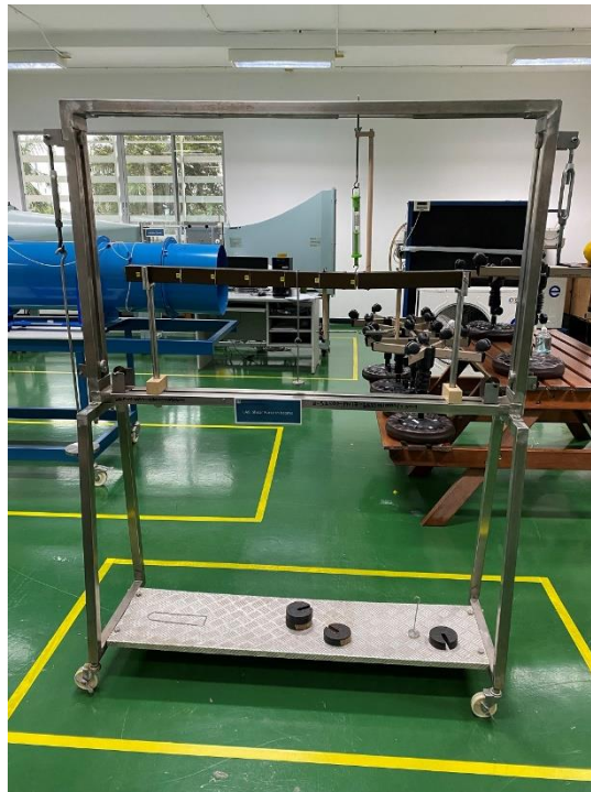
รูปที่ 8 เครื่องทดสอบแรงเฉือน (Shear Tester)
