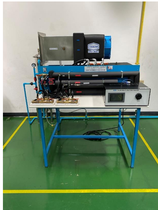
รูปที่ 14 ชุดวิเคราะห์อุปกรณ์แลกเปลี่ยนความร้อน (Heat Exchanger Test Unit)
