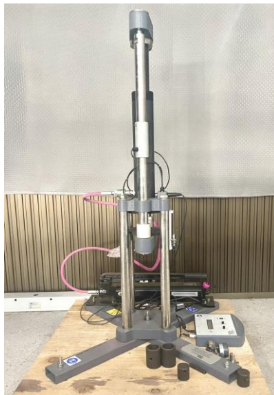
รูปที่ 5.7 ชุดปฏิบัติการทดสอบการดึงของวัสดุ
