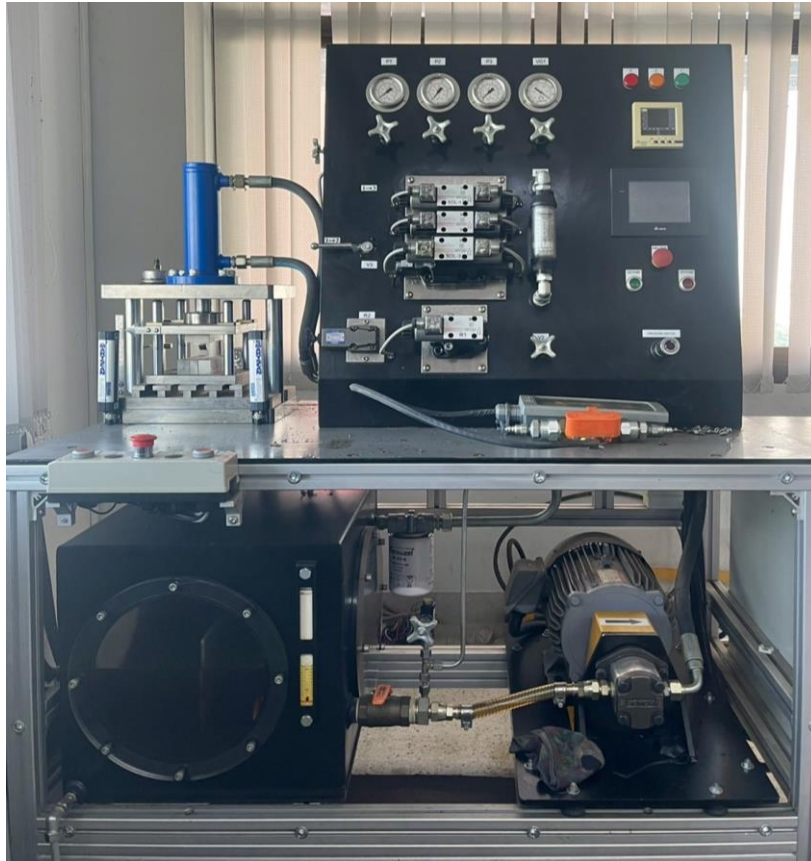
รูปที่ 5.27 ชุดทดลองระบบควบคุมไฮดรอลิกส์
