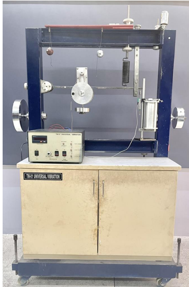
รูปที่ 5.15 ชุดปฏิบัติการการสั่นสะเทือนทางกล
