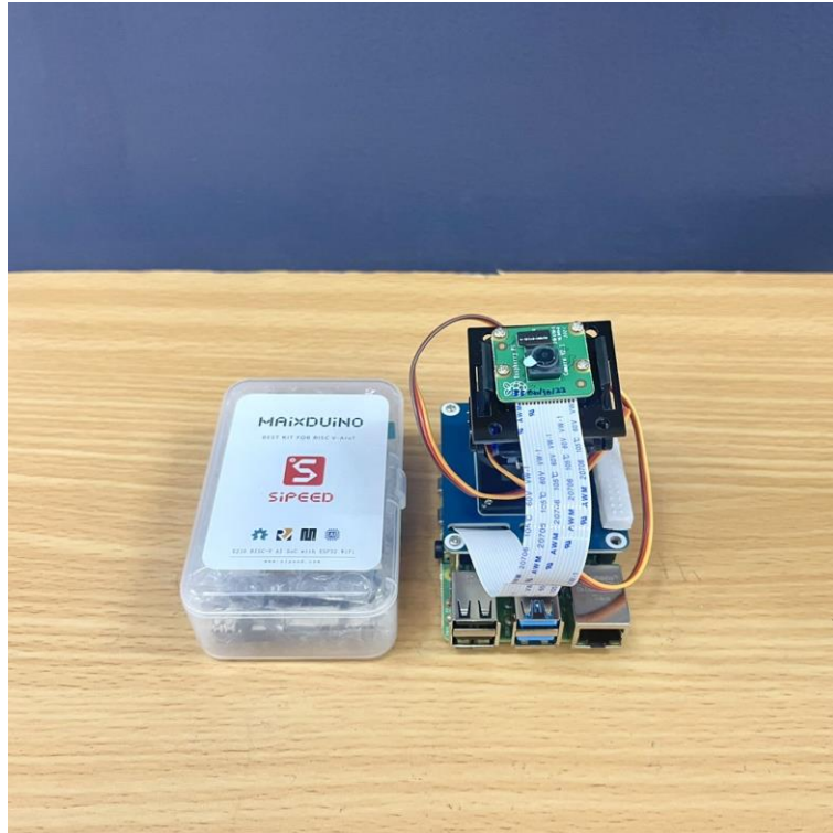
รูปที่ 5.29 ชุดทดลองระบบควบคุมอัตโนมัติแบบฝังตัว
