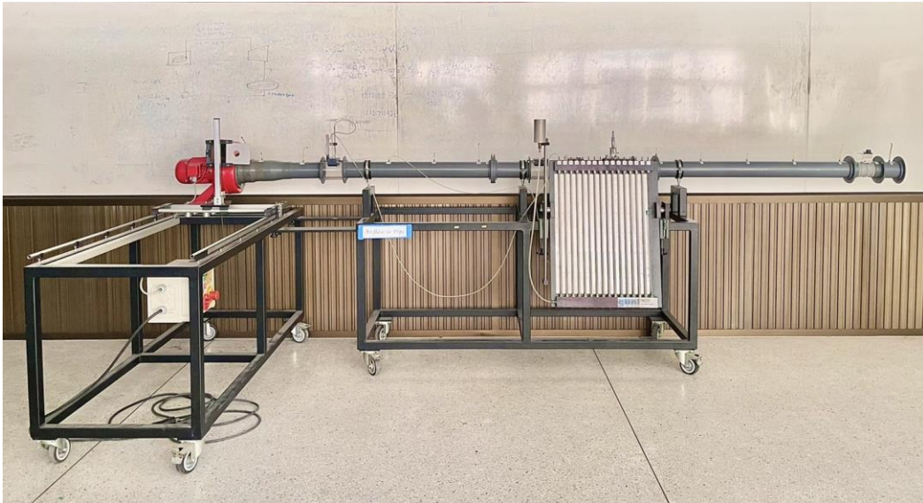
รูปที่ 5.11 ชุดปฏิบัติการโบลเวอร์ และ อัตราการไหลของอากาศ
