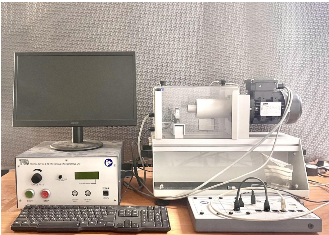
รูปที่ 5.9 ชุดปฏิบัติการทดสอบความล้าของวัสดุ
