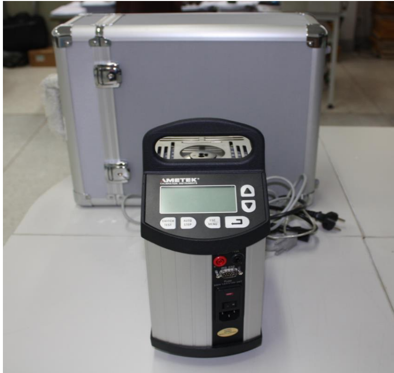
รูปที่ 5.23 ชุดปฏิบัติการสอบเทียบอุณหภูมิ
