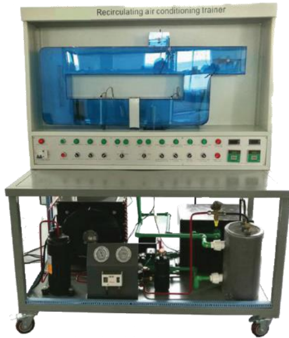
ภาพที่ 20 ชุดปรับอากาศแบบหมุนเวียน (Recirculating Air Conditioning Unit) สำหรับปฏิบัติการที่ 2/8
