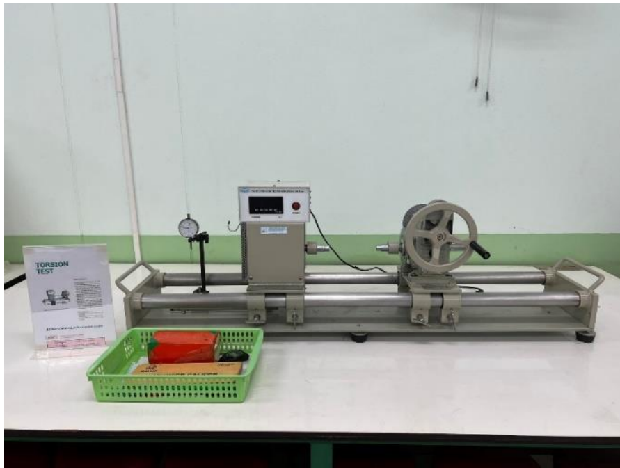
ภาพที่ 3 เครื่องทดสอบแรงบิด (Torsion Tester) สำหรับปฏิบัติการที่ 1/3
