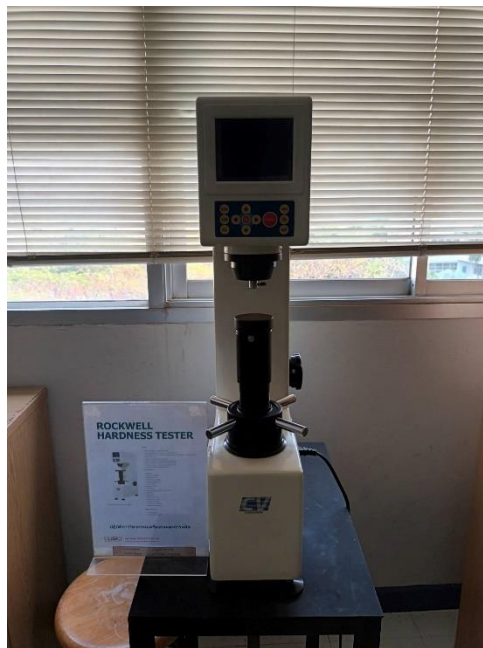
ภาพที่ 26 ภายในห้องปฏิบัติการ 7-419 สำหรับติดตั้งเครื่องทดสอบความแข็งแบบร็อคเวล
