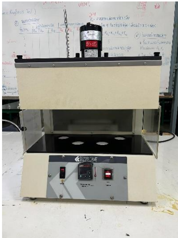
ภาพที่ 8 เครื่องวัดความหนืด (Saybolt viscosimeter) สำหรับปฏิบัติการ 1/8
