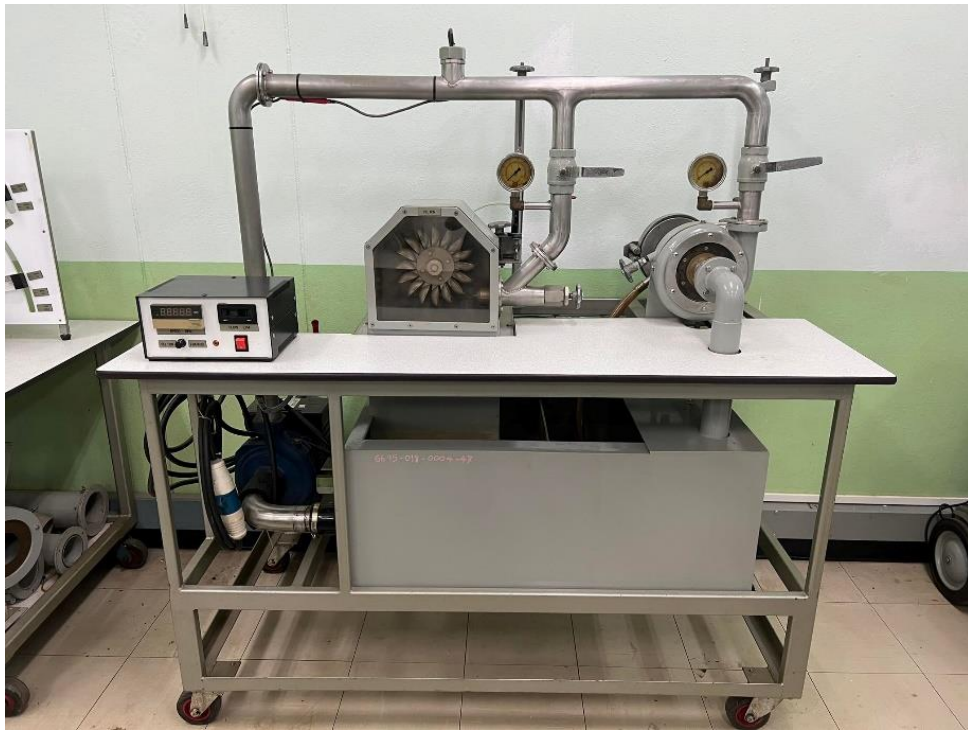
ภาพที่16 กังหันแบบเพลตันและกังหันแบบฟรานซิส (Compact Pelton and Francis Turbine Test Set) สำหรับปฏิบัติการที่ 2/4
