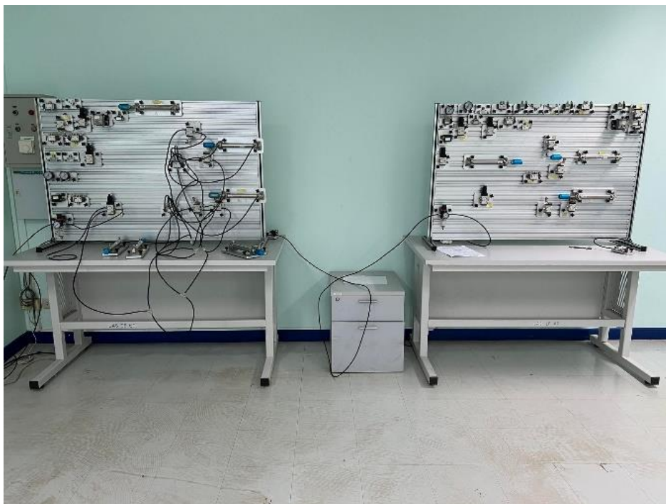
ภาพที่13 ระบบนิวเมติกส์แบบป้อนกลับ (Pnuematics: Feedback Control) สำหรับปฏิบัติการ 2/1
