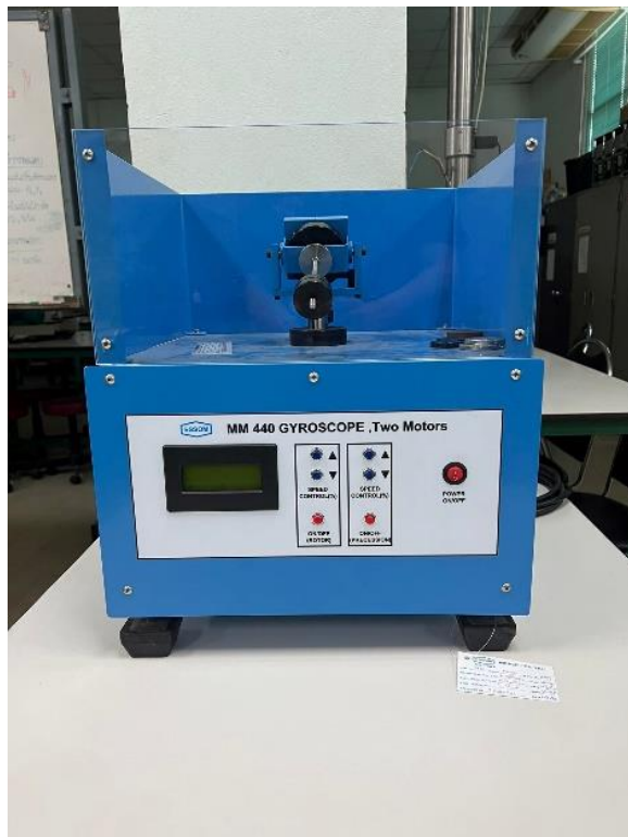
ภาพที่ 6 ไจโรสโคป (Gyroscope) สำหรับปฏิบัติการที่ 1/6
