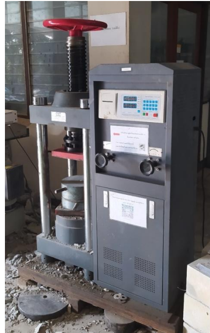
5. เครื่องทดสอบแรงกดคอนกรีต 2,000 กิโลนิวตัน
