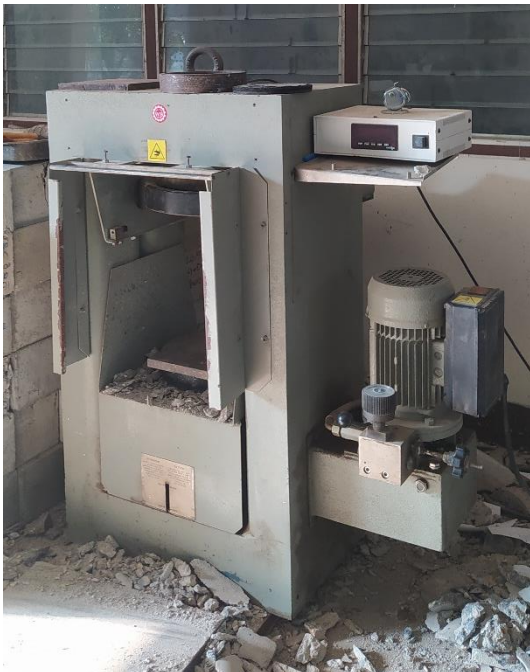
6. เครื่องทดสอบแรงกดคอนกรีตขนาด 3000 กิโลนิวตัน 7. เครื่องทดสอบแบบยูนิเวอร์แซล ขนาด 200 ตัน
