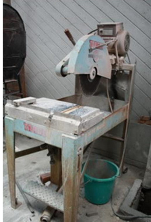
9. เลื่อยตัดคอนกรีต
