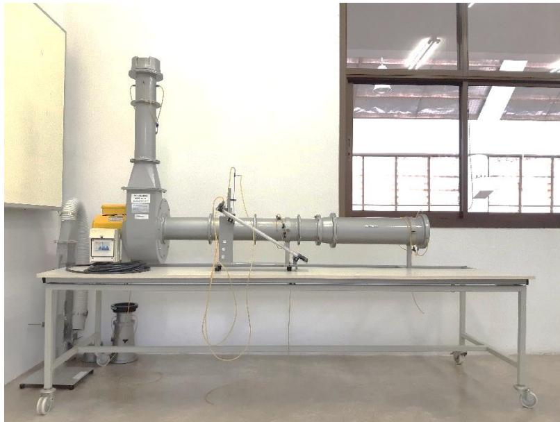
5.ชุดทดลองการวัดอัตราการไหลของอากาศ (Air Flow Bench)
