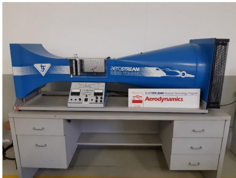
2. ชุดทดลองแรงต้านและแรงยกอากาศ (Mini-Wind Tunnel Test Set)
