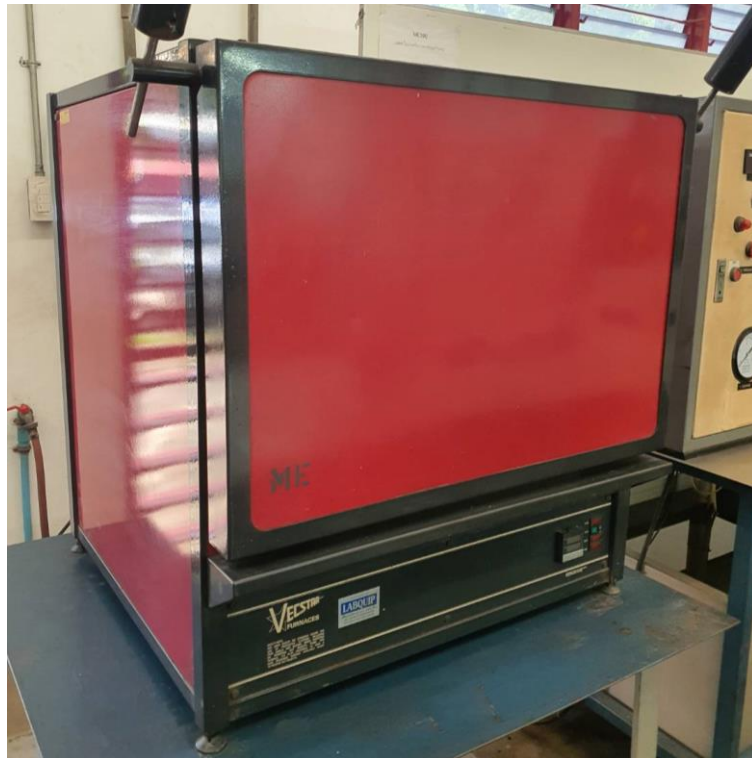
9.เตาเผาไฟฟ้าควบคุมอุณหภูมิ (Electric Muffle Furnace)
