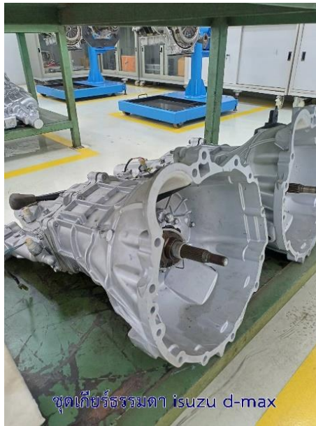
ชุดเกียร์ธรรมดาสำหรับรถประกอบ 6ชุด (shop me. 103)
