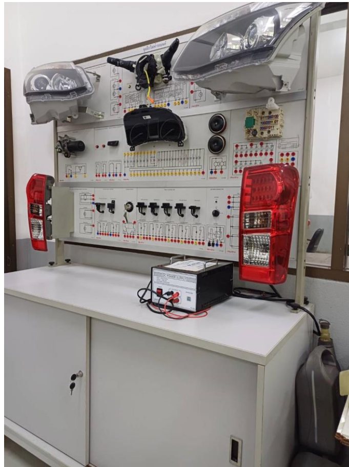
ชุดสาธิตวงจรแผงไฟฟ้ารถยนต์ isuzu d-max2015 (shop me. 103)
