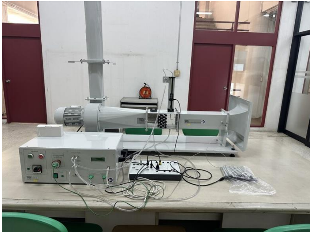
23.ชุดทดลองการแลกเปลี่ยนความร้อนแบบไหลวน (FLOW HEAT EXCHANGER)
