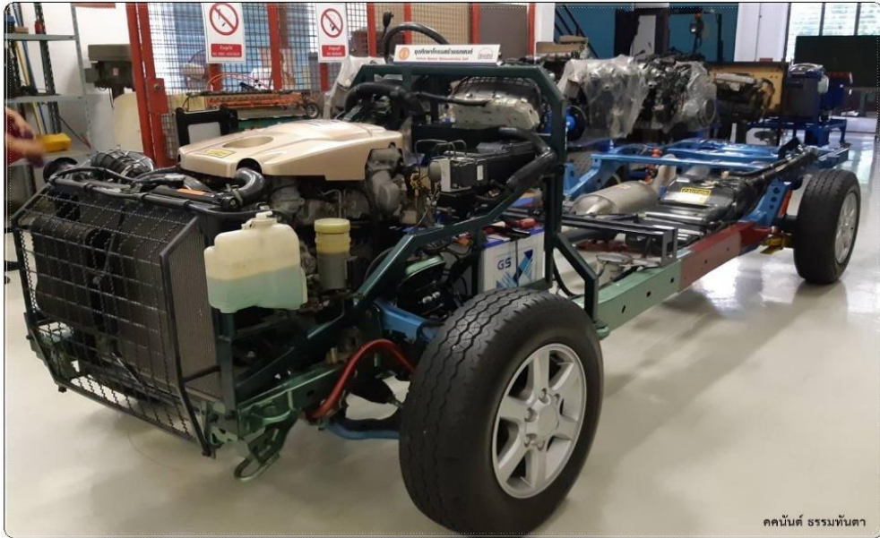
ระบบโครงสร้างช่วงล่างถังรถกระบะ isuzu แชนซี (Chassis) shop me1
