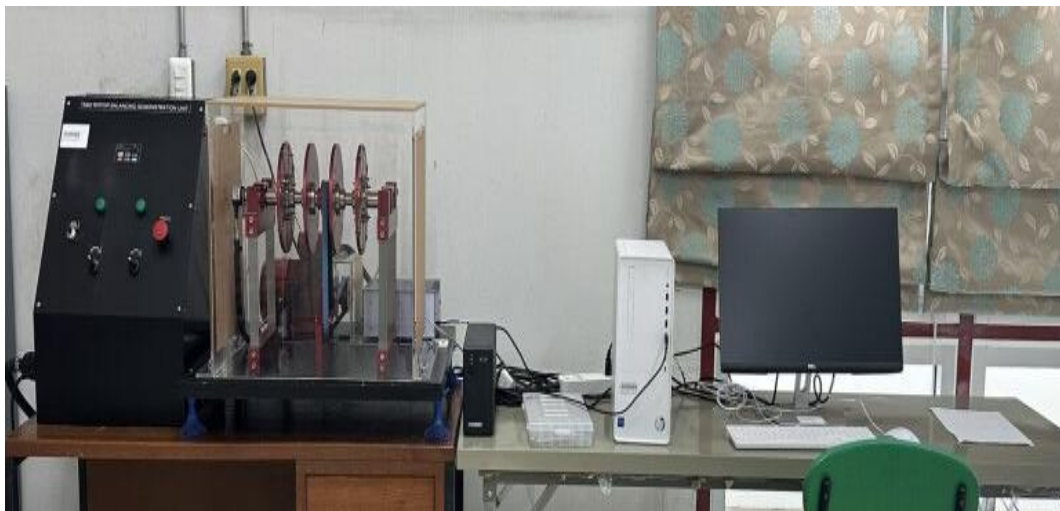
13. ชุดสาธิตหลักการสร้างสมดุลโรเตอร์ (TM02 ROTOR BALANCING DEMONSTRATION UNIT) ห้อง 210-1
