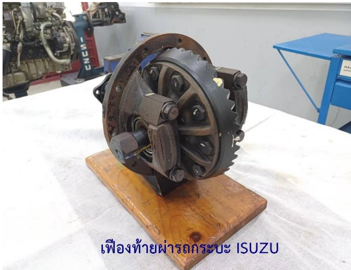
ชุดสาธิตเฟืองท้ายผ่ารถกระบะ ISUZU
