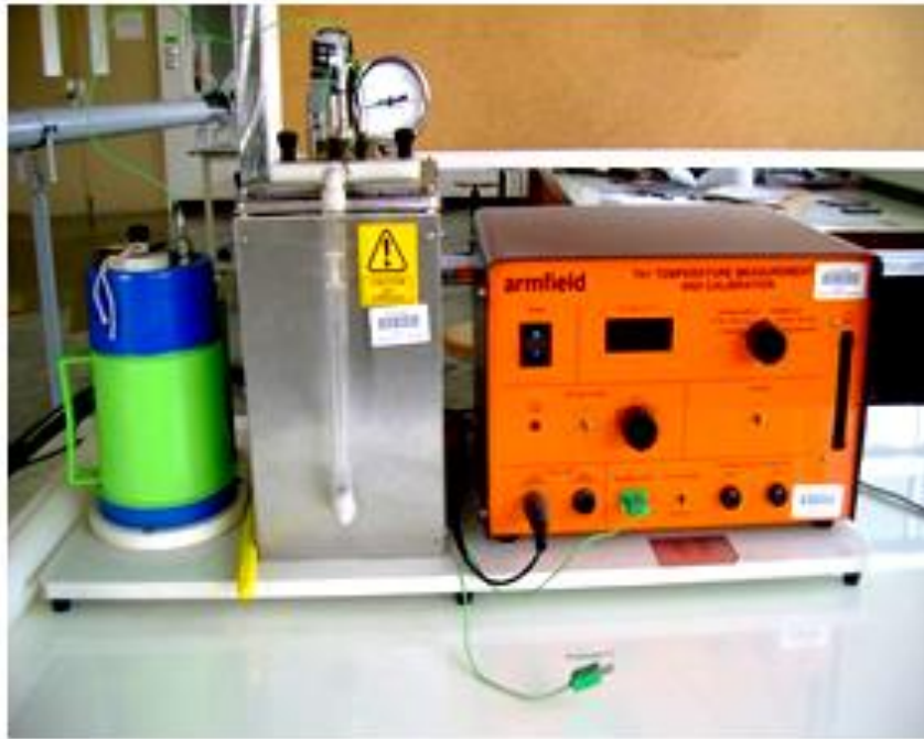
17.ชุดทดลองการวัดอุณหภูมิ (Temperature Measurement Bench)
