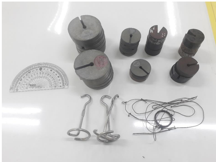
รูปที่ 5.2 มวลถ่วงและเชือกสำหรับการทดลองการสมดุลในโครงสร้าง
