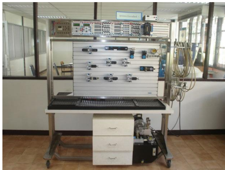
รูปที่ 5.62 แสดงชุดทดลองไฮดรอลิกส์ควบคุมด้วยไฟฟ้าและโปรแกรมเมเบิลคอนโทรล
