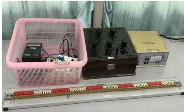
รูปที่ 5.28 เครื่องมือสำหรับการหาค่าความต้านทานทางไฟฟ้า
