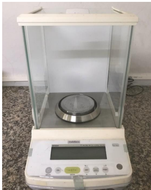
รูปที่ 5.18 เครื่องชั่งไฟฟ้าระบบแม่เหล็กไฟฟ้า ทศนิยม 4 ตำแหน่ง ยี่ห้อ SHIMADZU รุ่น ATX224
