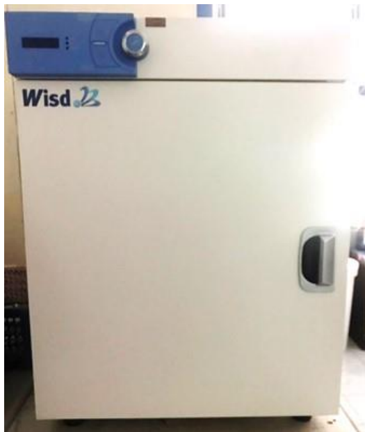
รูปที่ 5.17 ตู้บ่มร้อน ยี่ห้อ Wisd รุ่น WOF-105
