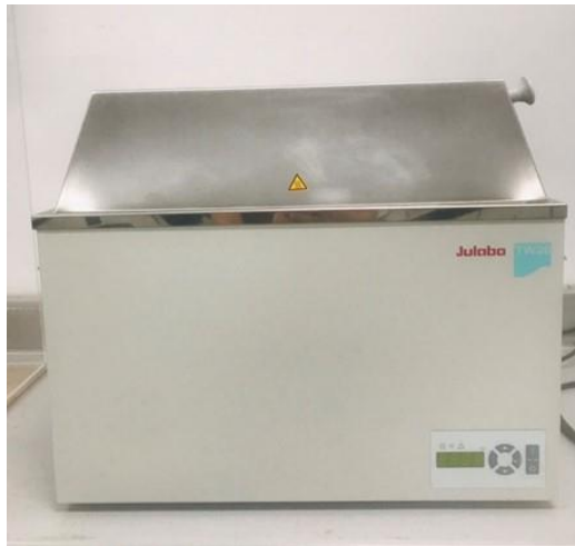
รูปที่ 5.16 อ่างควบคุมอุณหภูมิ ยี่ห้อ Julabo รุ่น TW20
