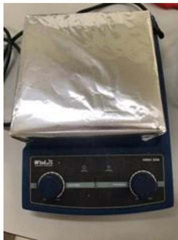
รูปที่ 5.11 เครื่องกวนสารละลายพร้อมให้ความร้อน ยี่ห้อ Wisd รุ่น MSH-20A
