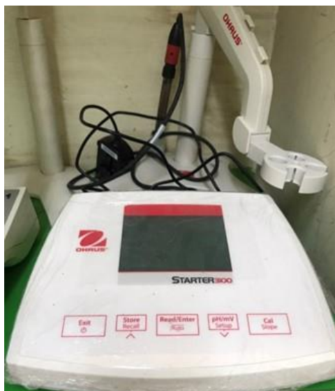
รูปที่ 5.13 เครื่องวัดความเป็นกรด-ด่าง ยี่ห้อ OHAUS รุ่น ST3100
