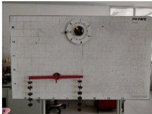
รูปที่ 5.31 เครื่องมือสำหรับการหาสมมูลของแรงและแรงบิด
