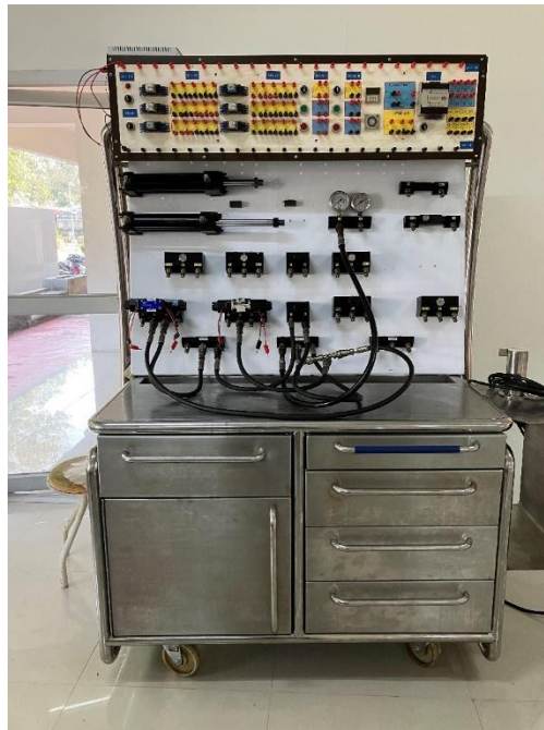
รูปที่ 5.63 แสดงชุดทดลองไฮดรอลิกส์ควบคุมด้วยไฟฟ้าและโปรแกรมเมเบิลคอนโทรล
