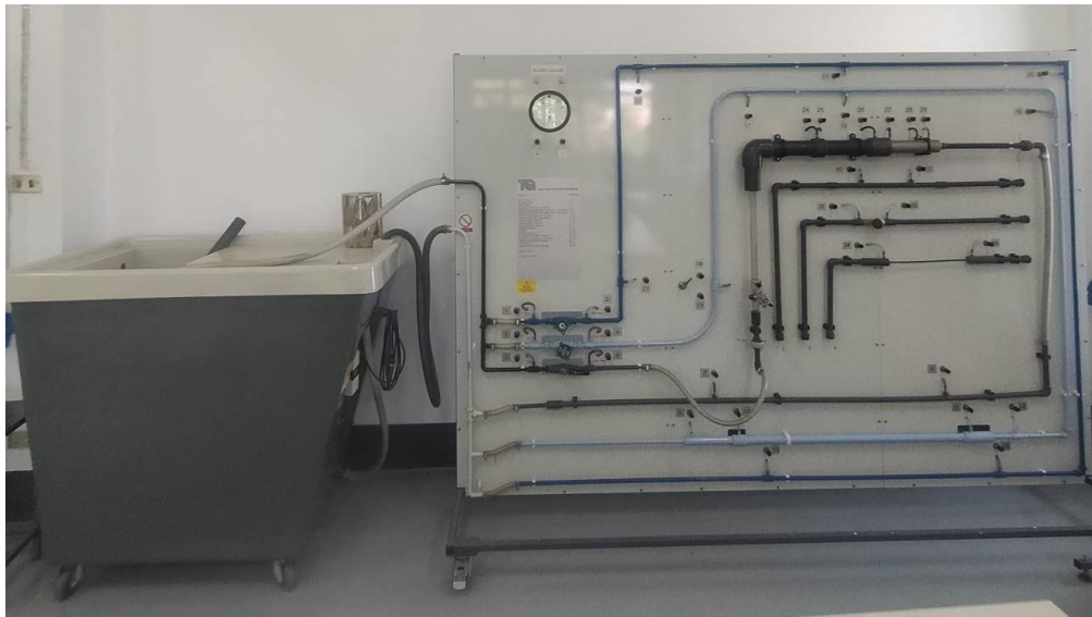
รูปที่ 5.52 Friction Loss in Pipe
