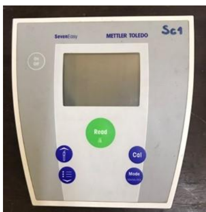
รูปที่ 5.14 เครื่องวัดค่าการนำไฟฟ้า (Conductivity meter) ยี่ห้อ METTLER TOLEDO
