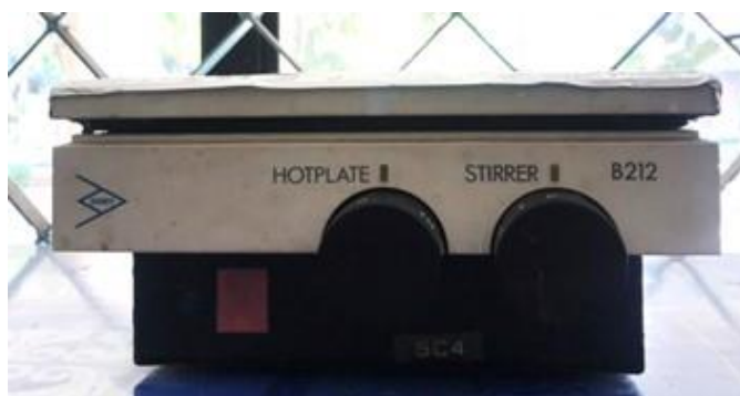
รูปที่ 5.12 เครื่องกวนสารละลายพร้อมให้ความร้อน BIBBY รุ่น B212
