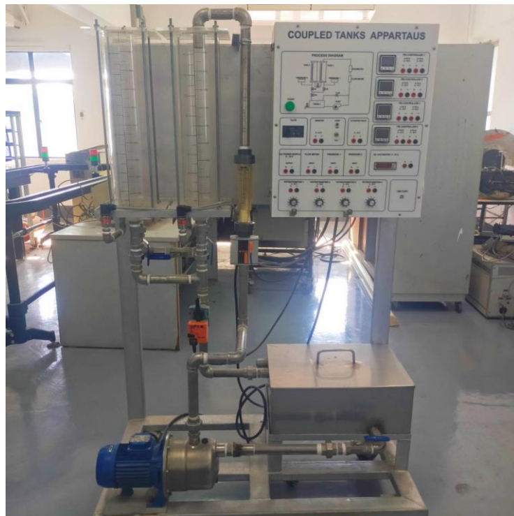
รูปที่ 5.59 การควบคุมระดับของเหลว (Level Control)
