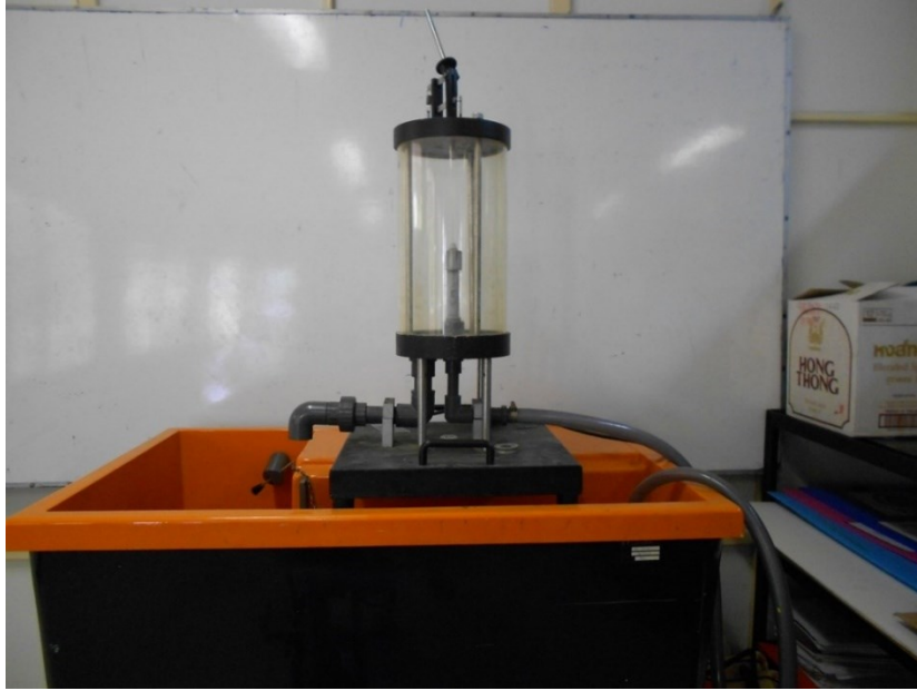
รูปที่ 1.7 แสดงชุดทดลอง Impact of Water Jet
