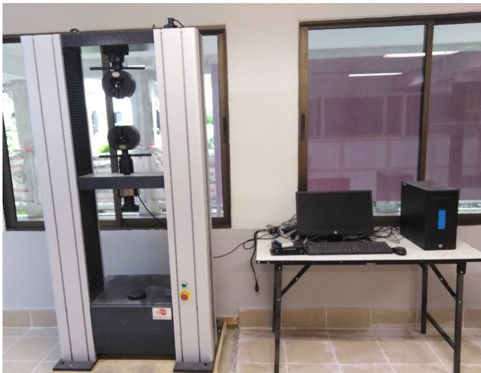
รูปที่ 1.8 แสดงเครื่องทดสอบ Universal Testing Machine (Model WDW-100)
