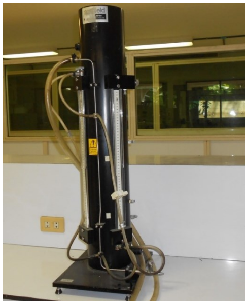
รูปที่ 1.4 แสดงชุดทดลอง การสูญเสียพลังงานในท่อ (Energy Loss in Pipe)
