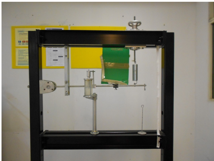
รูปที่ 1.1 แสดงชุดทดสอบ Vibration Test Set
