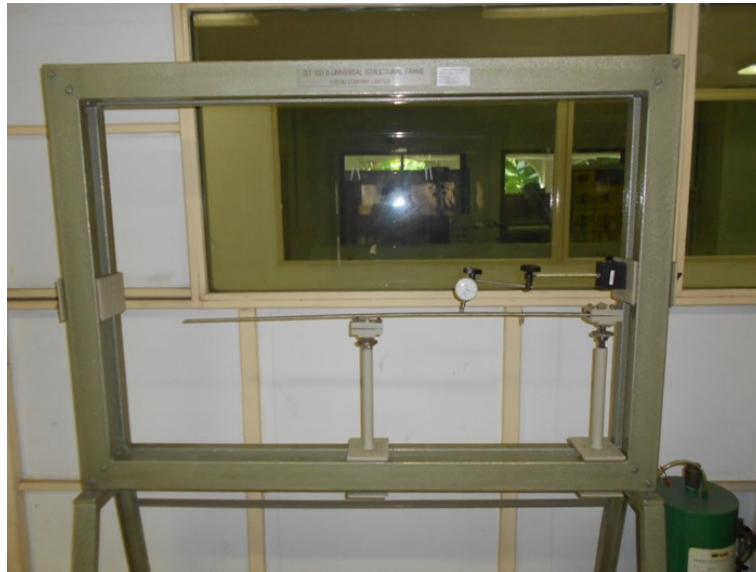
รูปที่ 1.6 แสดงชุดทดสอบการโก่งงอของคาน (Bending Test set)
