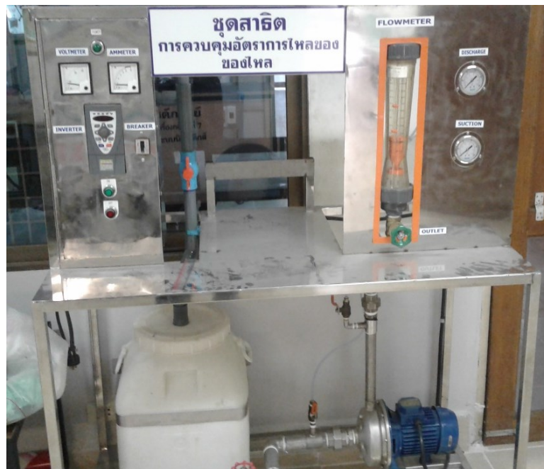
รูปที่ 1.9 แสดงชุดทดลอง Centrifugal Pump Test Set
