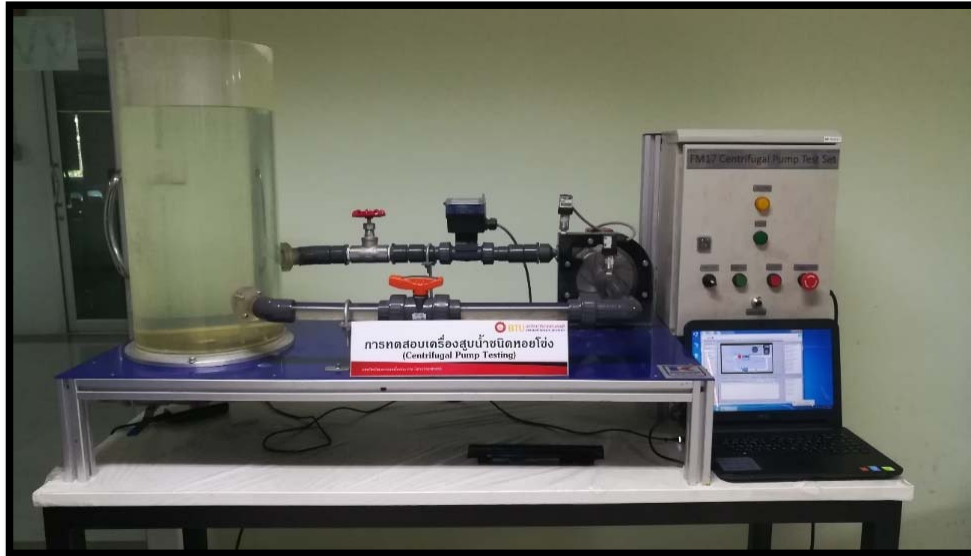
ภาพ 4.10 ชุดปฏิบัติการ Centrifugal Pump Test Set
