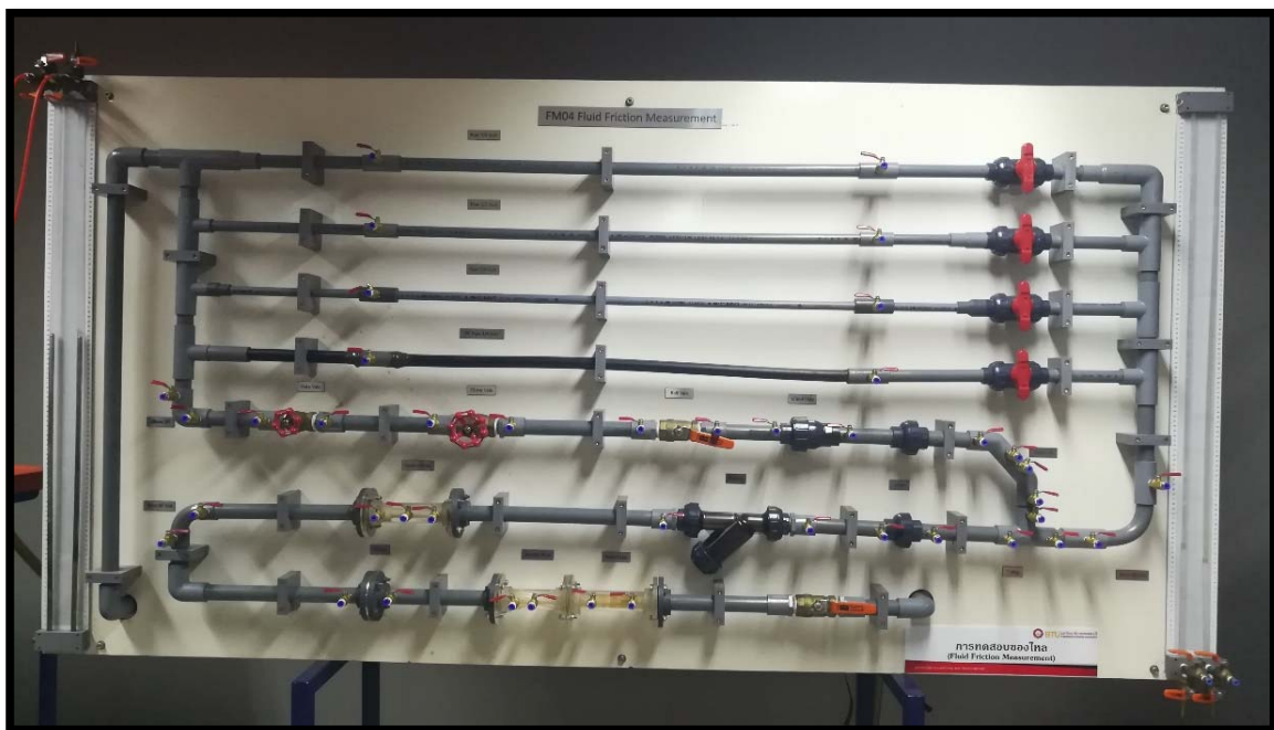
ภาพ 4.14 ชุดปฏิบัติการ Flow or Friction Loss in Pipe
