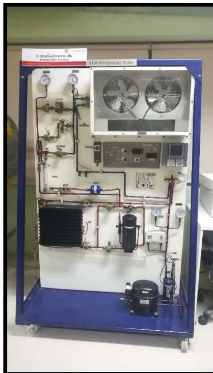
ภาพ 4.18 ชุดปฏิบัติการ Refrigeration System Unit
