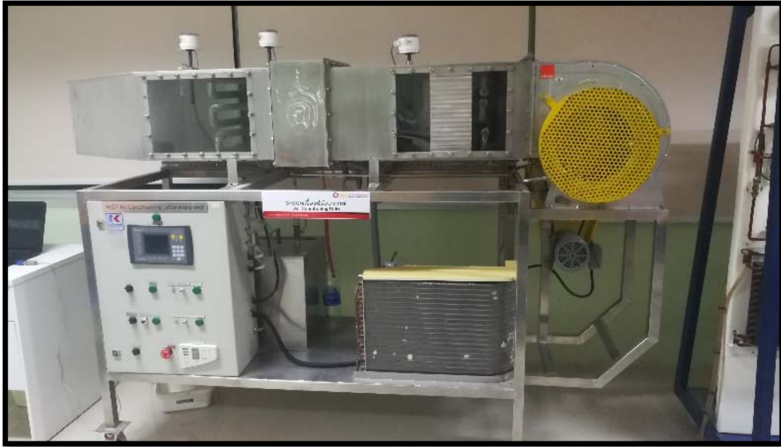
ภาพ 4.19 ชุดปฏิบัติการ Air Conditioning Unit
