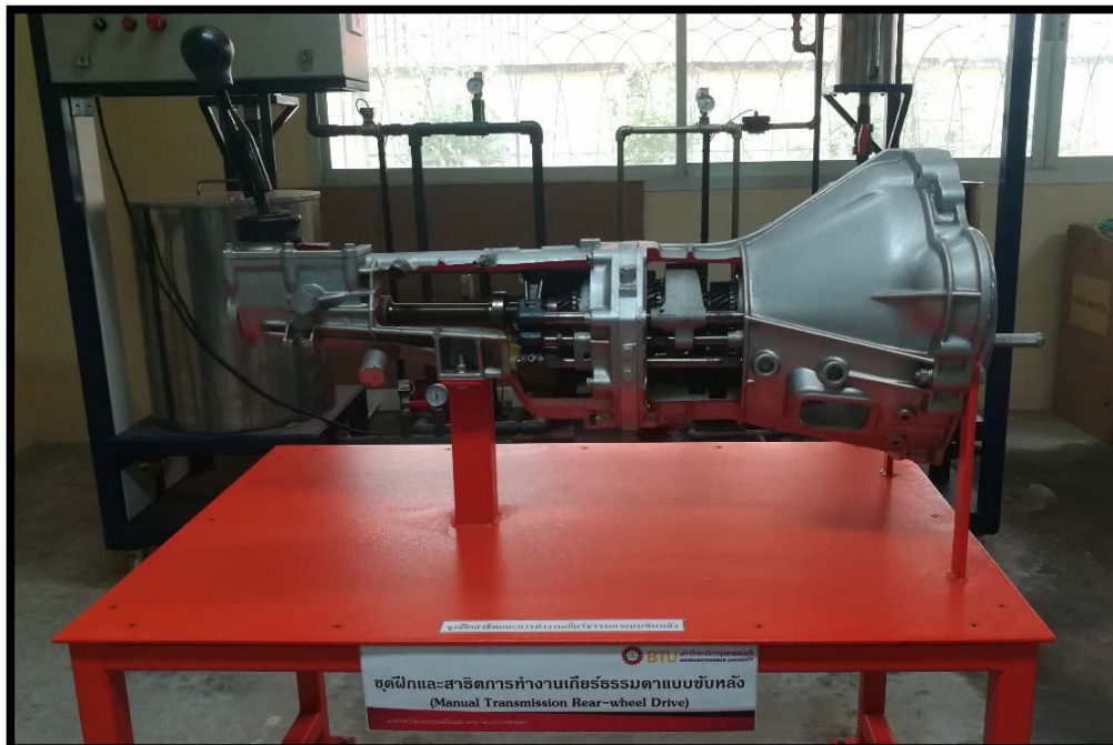
ภาพ 4.25 ชุดฝึกและสาธิตเกียร์ธรรมดาขับเคลื่อนล้อหลัง
