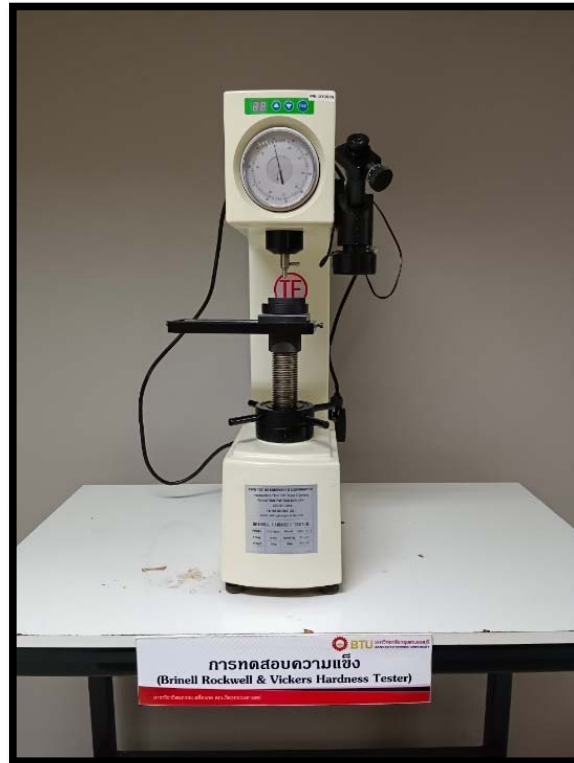
ภาพ 4.7 ชุดปฏิบัติการ Brinell , Rockwell & Vickers Hardness Tester
