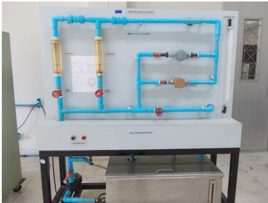
รูปที่ 4.7 ชุดทดลองการวัดอัตราการไหลของของไหล
