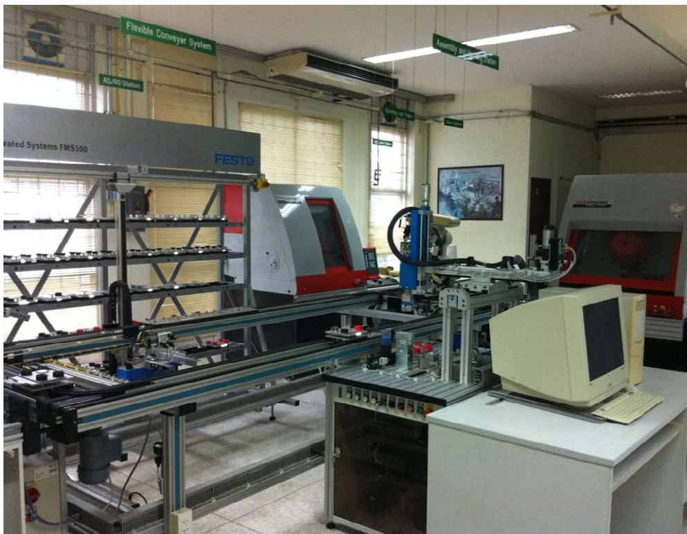
รูปที่ 9.1 ชุดทดลองระบบการผลิตรวมควบคุมด้วยระบบคอมพิวเตอร์
