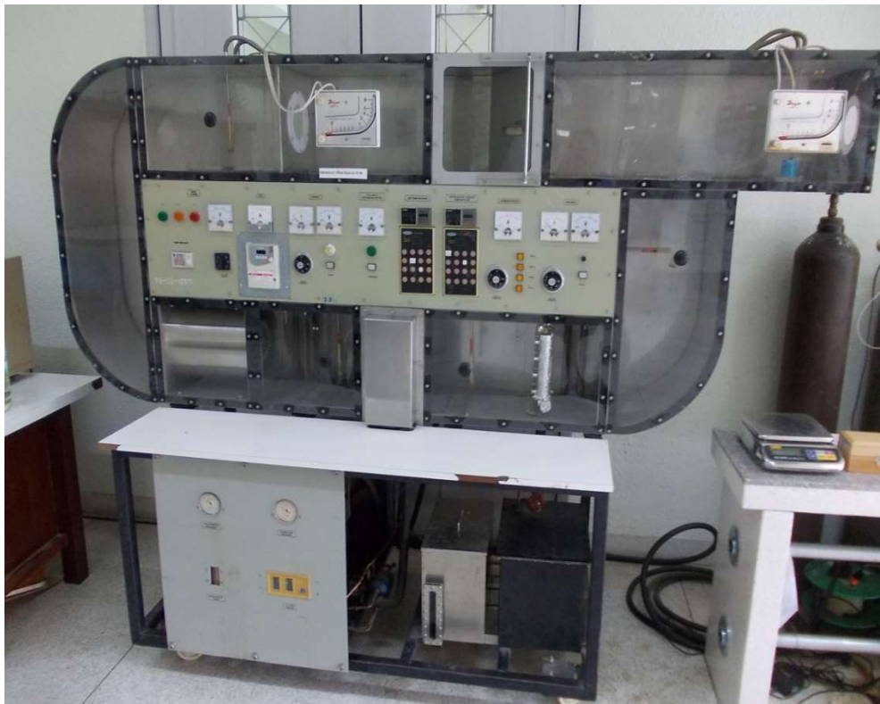
รูปที่ 5.9 ชุดทดลองระบบปรับอากาศ
