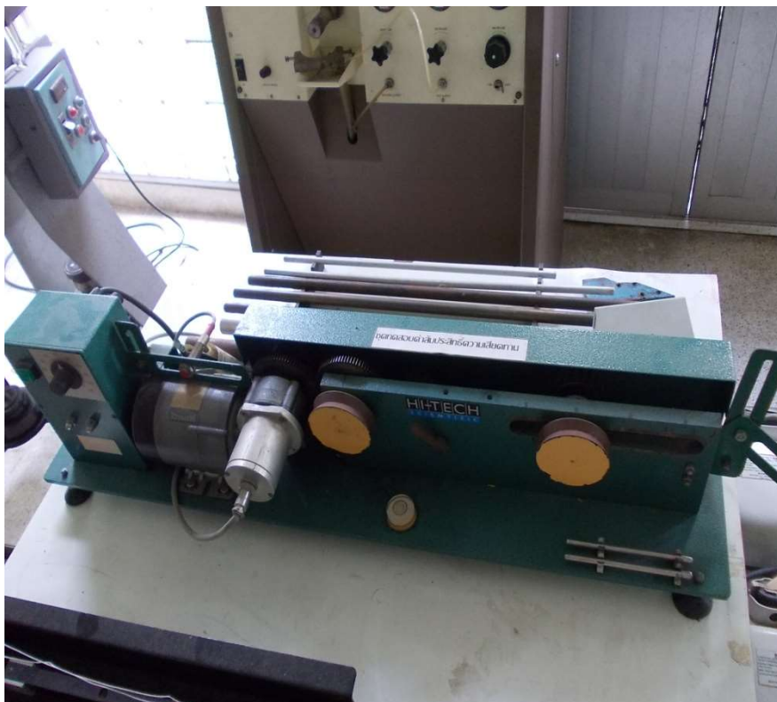
รูปที่ 3.10 ชุดทดลองหาค่าสัมประสิทธิ์ความเสียดทาน
