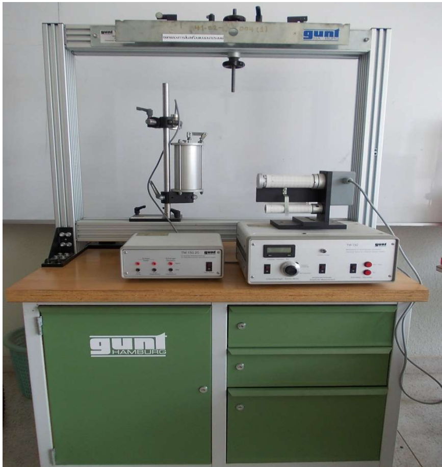
รูปที่ 3.13 ชุดทดลองการสั่นสะเทือนแบบเอนกประสงค์
