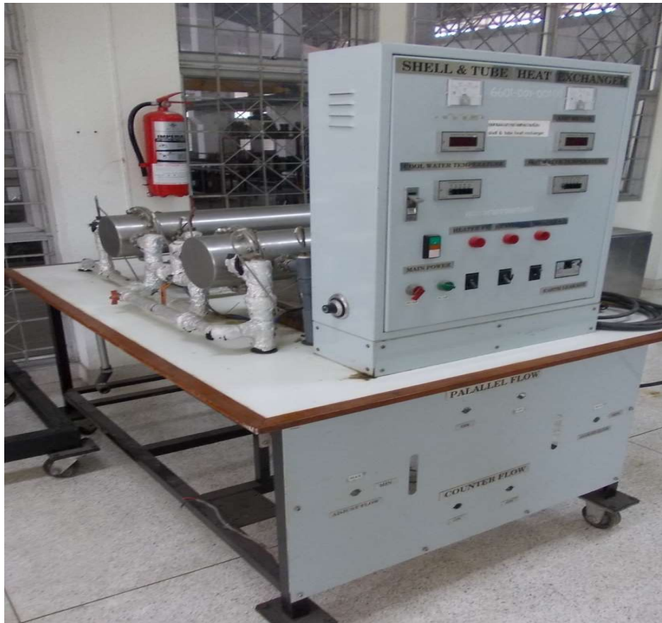
รูปที่ 5.2 ชุดทดลองอุปกรณ์แลกเปลี่ยนความร้อนแบบท่อและถัง
