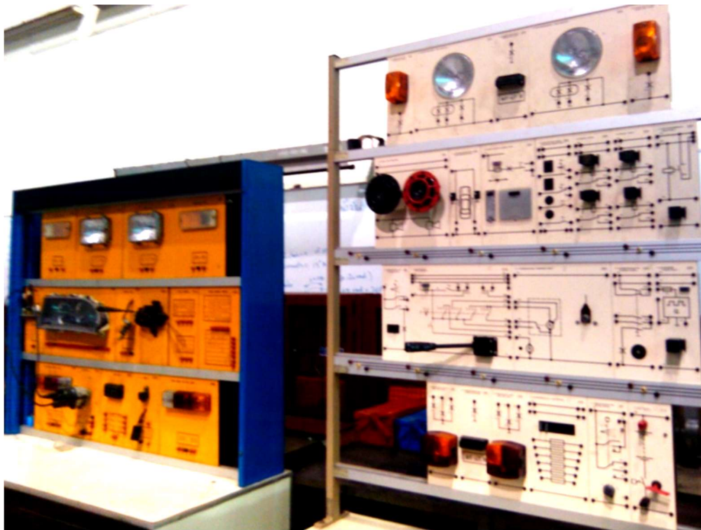
รูปที่ 1.4 ชุดสาธิตระบบไฟฟ้ารถยนต์
