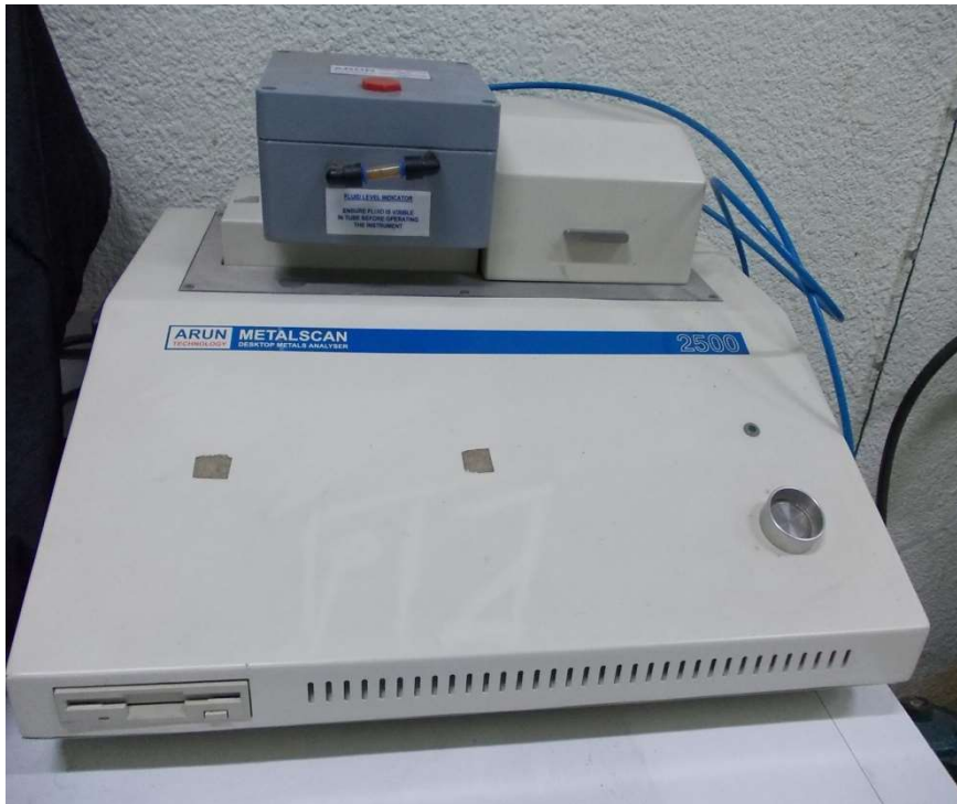
รูปที่ 3.9 เครื่องวิเคราะห์ธาตุผสมโลหะ
