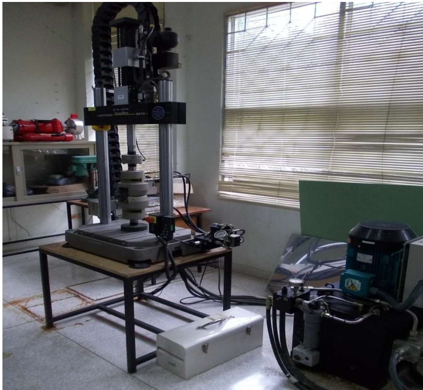
รูปที่ 3.11 เครื่องทดสอบแรงดึง - แรงกด ขนาด 25 kN
