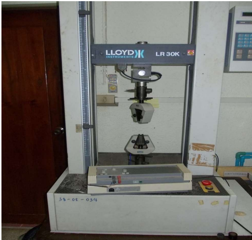
รูปที่ 3.3 เครื่องทดสอบแรงดึง - แรงกดวัสดุขนาด 30 kN
