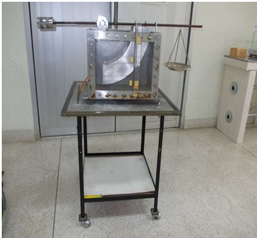
รูปที่ 4.1 ชุดทดลองจุดศูนย์กลางความดัน
