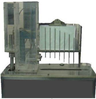
การทดสอบหาค่าสัมประสิทธิ์ต่างๆของออร์ฟิสนขนาดเล็ก
