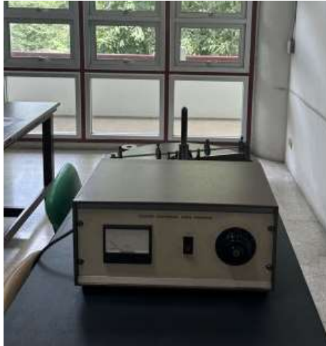
9.ชุดทดลองแรงเข้าสู่ศูนย์กลาง (Centripetal Force Apparatus) CUSSONS P2799 ผังห้อง 203
