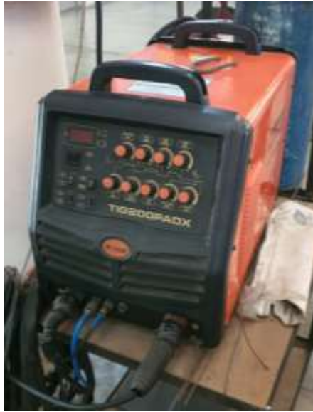
10.ตู้เชื่อมโลหะ 2 ระบบ (Inverter Dual System Welding Machine) JASIC : KT Max weld ผังห้อง .(ชั้น1) อาคารปฏิบัติการ วิศวกรรมเครื่องกล
