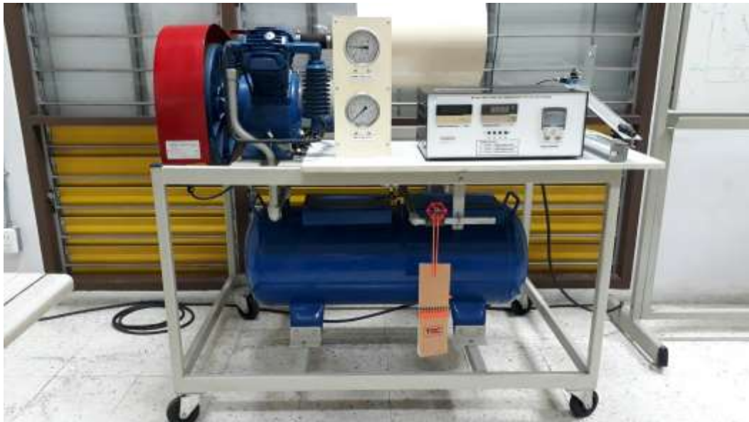
19.ชุดทดลองเครื่องอัดอากาศแบบ2ระดับ (TWO STAGE AIR COMPRESSOR TEST SET) ESSOM MP202 ห้อง 206 ชั้น 2
