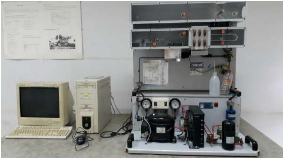
20.ชุดสาธิต วัฏจักรการทำความเย็น (Refrigeration Cycle Demonstration Unit) GUNT ET 915.07 ห้อง 206 ชั้น 2
