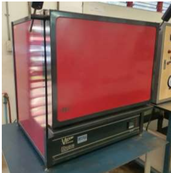
9.เตาเผาไฟฟ้าควบคุมอุณหภูมิ (Electric Muffle Furnace) Vecstar : TRF3 ผังห้อง (ชั้น1) อาคารปฏิบัติการ วิศวกรรมเครื่องกล
