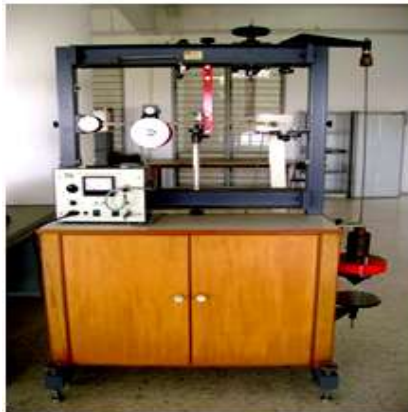
10.ชุดทดลองการสั่นสะเทือน (Free and Forced Vibration Test Set) TQ TM16 ผังห้อง 203
