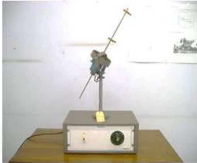
7.ชุดทดลองไจโรสโคปแบบตั้งโต๊ะ (Gyroscopic Motion) CUSSONS P5377
