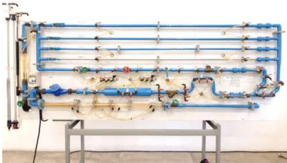
6. ชุดทดลองการสูญเสียความฝืดในท่อ (COMPACT PIPING LOSS TEST SET) ESSOM HF- 135C ฝั่งห้อง 205
