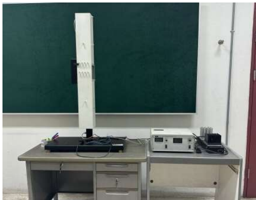
22.ชุดทดลองการพาความร้อนแบบอิสระและถูกบังคับ (Free and Forced Convection Study Unit) GUNT WL 350 HT ห้อง 207 ชั้น 2
