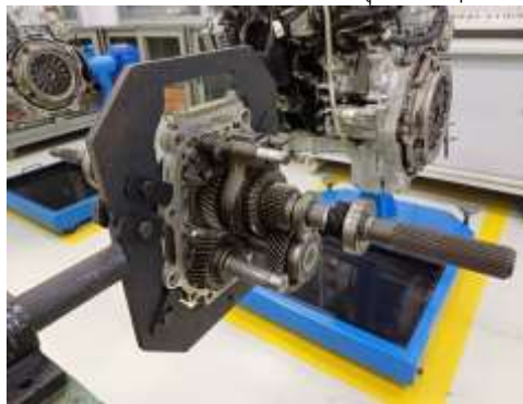
ชุดเฟืองเกียร์สำหรับถอดประกอบ 2ชุด (shop me. 103)
