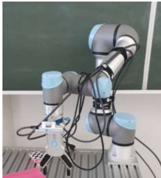
15.หุ่นยนต์แขนกลควบคุม6แกน (Position Control of 6 Axis Robot Arm) Universal Robots : UR5e ฟังห้อง วศ. 631 อาคาร อำนวยการ
