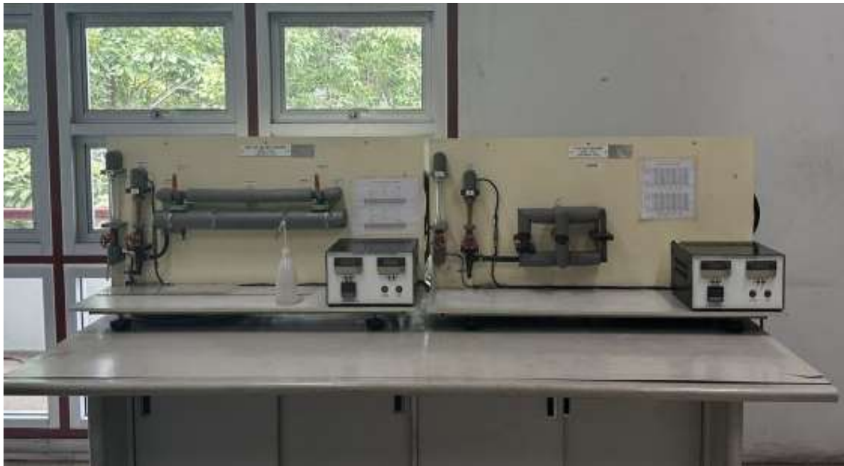
21.ชุดทดลองการเปลี่ยนแปลงความร้อน (PLATE HEAT EXCHANGER MODEL TH 221), (SHELL AND TUBE HEAT EXCHANGER MODEL TH 221) ห้อง 206 ชั้น 2
