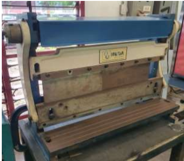
8.เครื่องตัดพับ โลหะแผ่น (Cut and Bending Machine) MEGA : 3-IN-1/610 ผังห้อง (ชั้น1) อาคารปฏิบัติการ วิศวกรรมเครื่องกล
