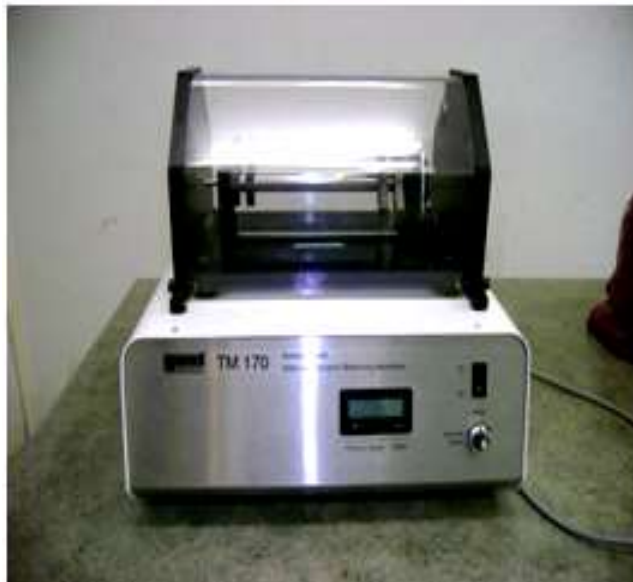
12.ชุดทดลองความสมดุลของเครื่องจักร (Static and Dynamics Balancing Apparatus) GUNT TM 170
