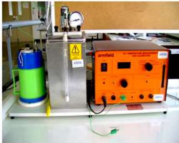
17.ชุดทดลองการวัดอุณหภูมิ (Temperature Measurement Bench) ARMFIELD TH1 ห้อง 201 ชั้น 2
