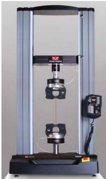
16.เครื่องทดสอบแรงดึง (Tensile strength tester) Instron : 5969 ผังห้อง วจ. 308 อาคารปฏิบัติการและวิจัย
