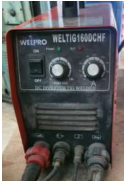
12. ตู้เชื่อมอาร์กอน (TIG Welding Machine) WELPRO : Weltig160DCHF ฝั่งห้อง (ชั้น1) อาคารปฏิบัติการ วิศวกรรมเครื่องกล
