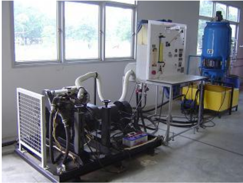
รูปที่ 4.2 Engine testbed
