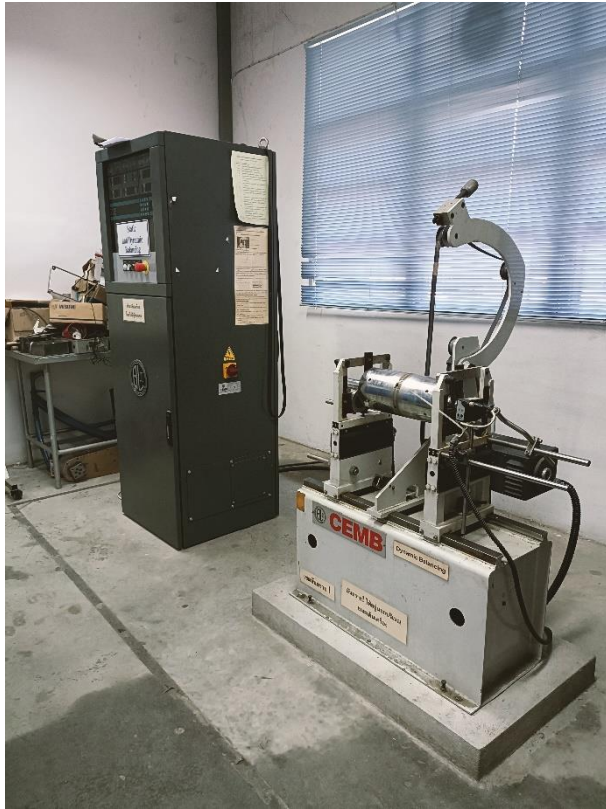
รูปที่ 3.2 Static and Dynamic Balancing
