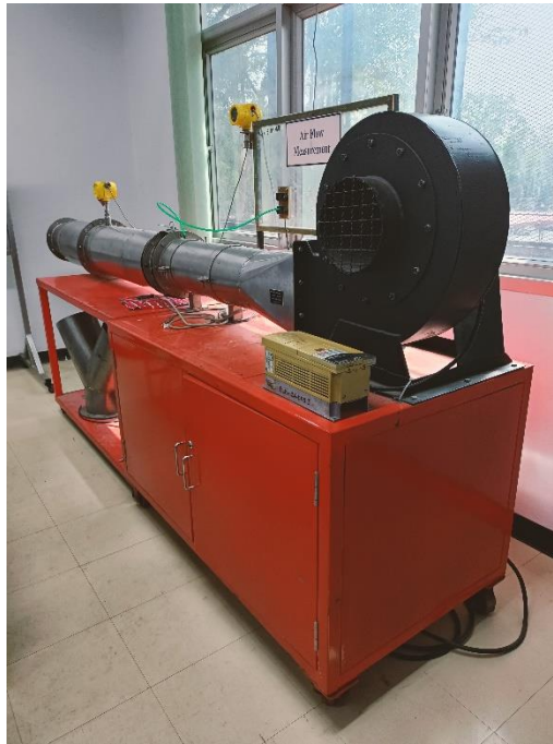
รูปที่ 1.1 Air flow measurement
