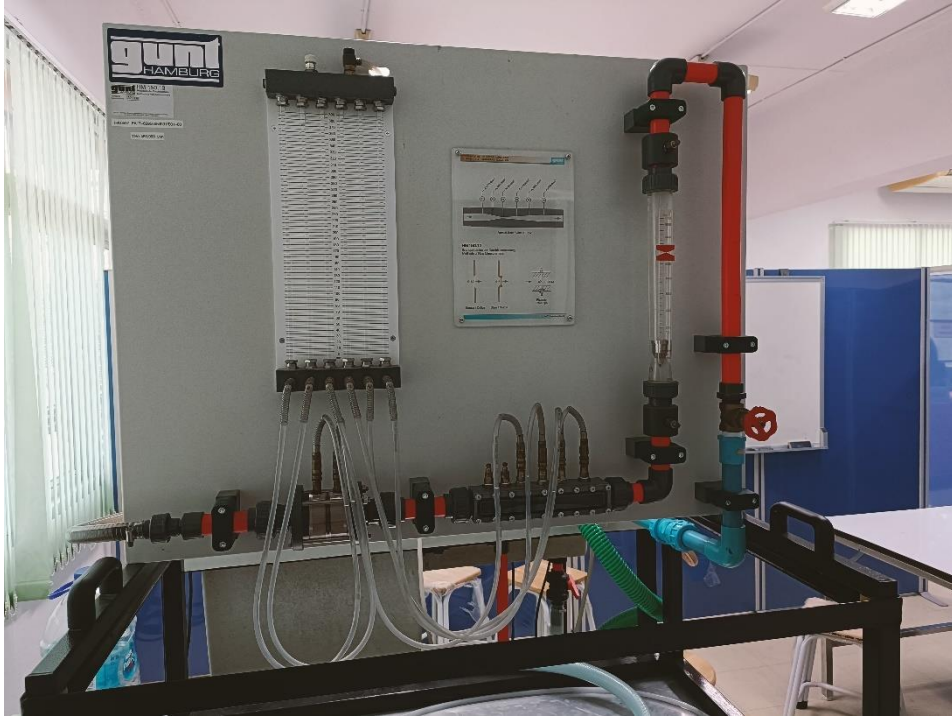
รูปที่ 1.7 Methods of flow Measurement
