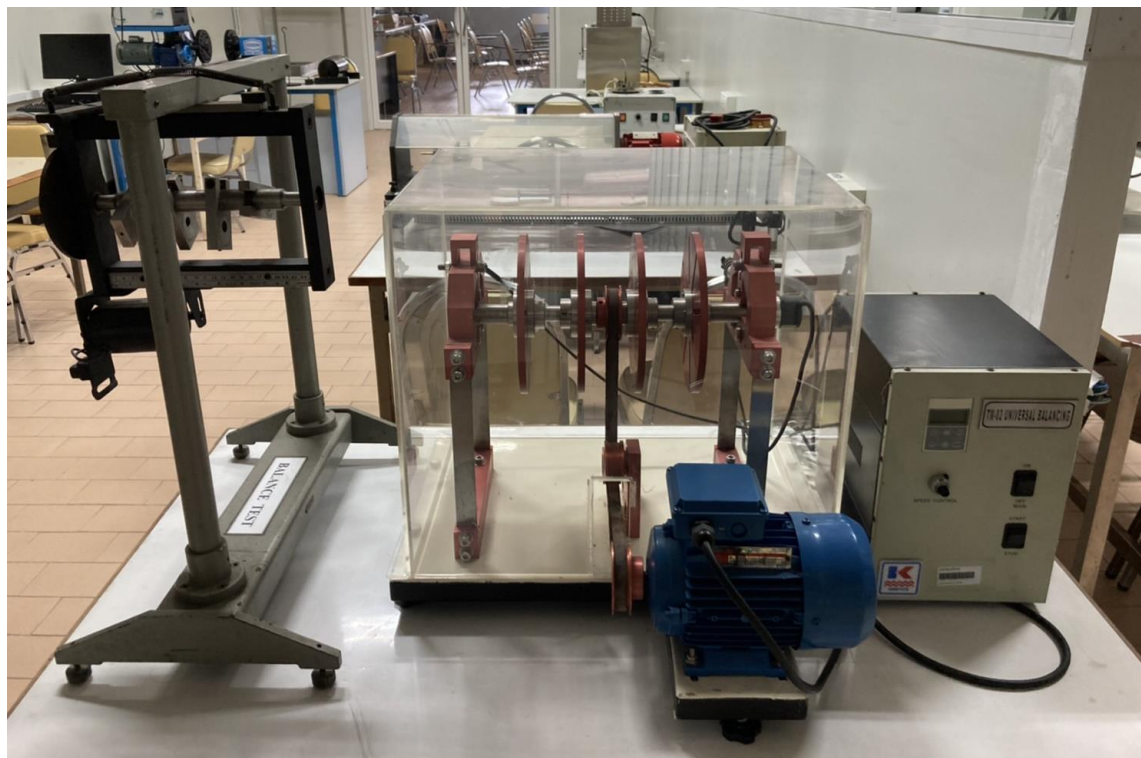
ชุดทดลอง Universal Balancing
