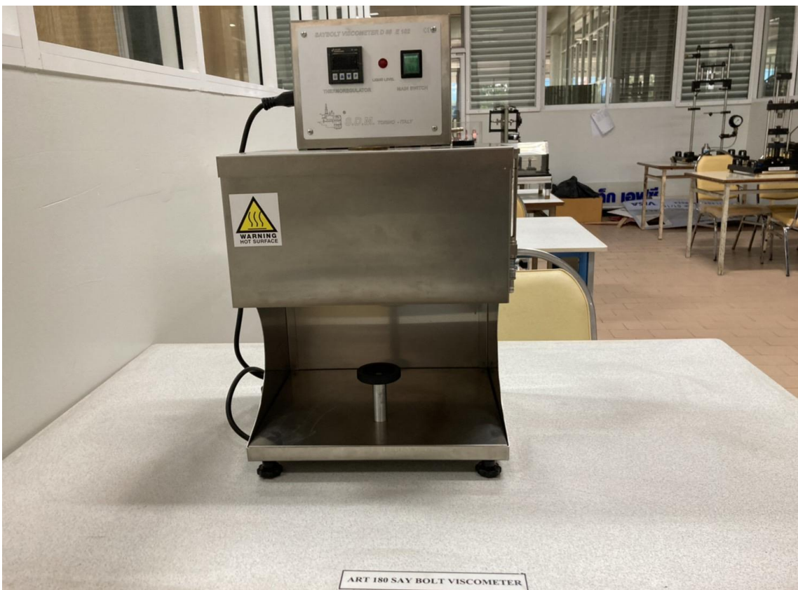
ชุดทดลองการวัดความหนืดของน้ำมัน
