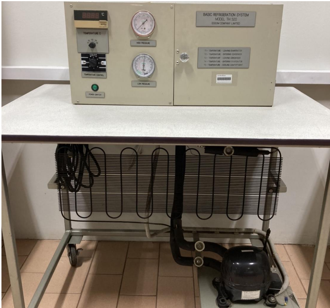
ชุดทดลอง Refrigeration System
