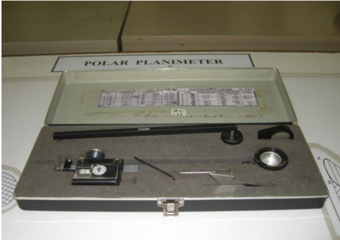
ชุดทดลอง Polar Planimeter
