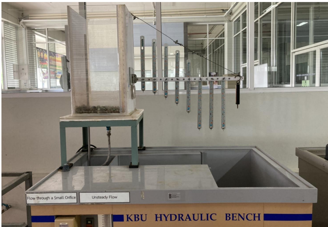
ชุดทดลองการไหลของลำน้ำอิสระที่ออกจากหัวฉีด
