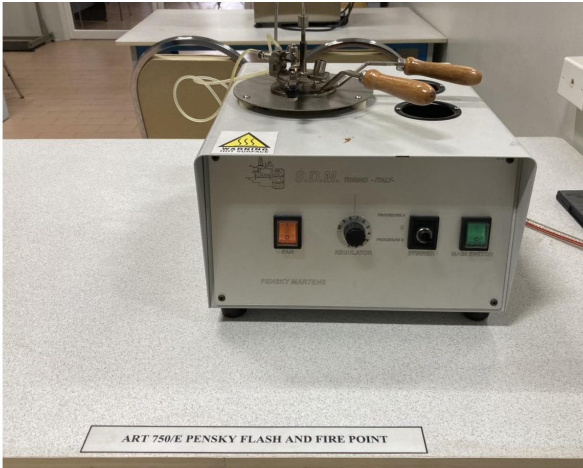
ชุดทดสอบจุดวาบไฟและจุดติดไฟ
