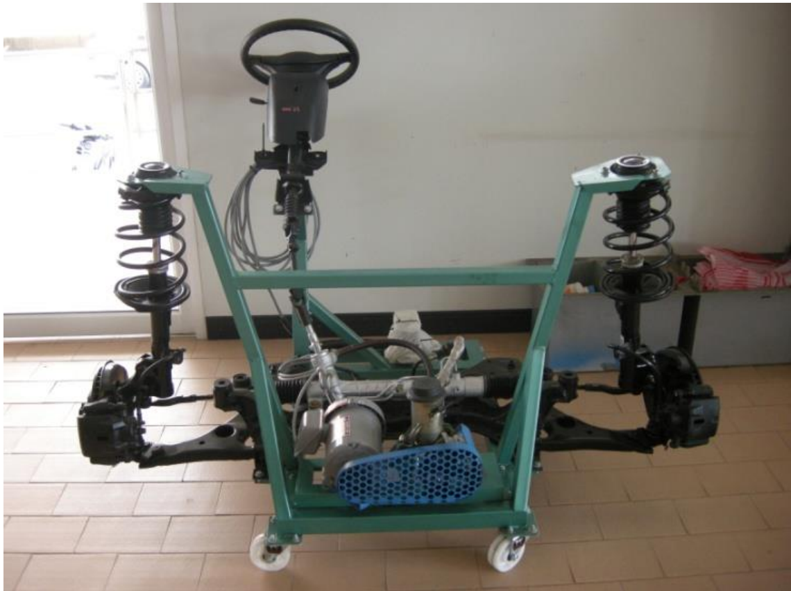
ชุดระบบบังคับเลี้ยวและรองรับการสั่นสะเทือน
