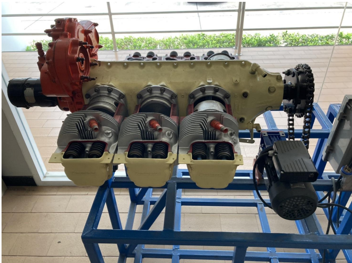
ชุดผ่าเครื่องยนต์ลูกสูบเครื่องบินเล็ก
