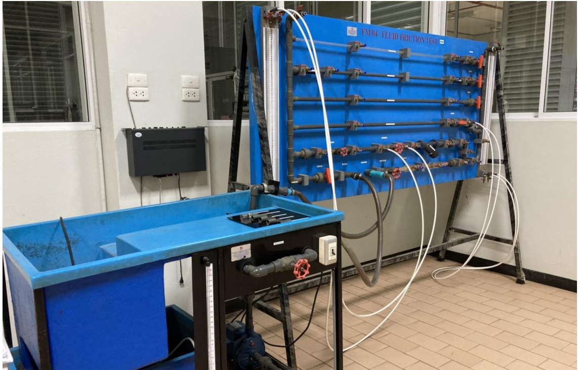
ชุดทดลองการสูญเสียความดันในระบบท่อ
