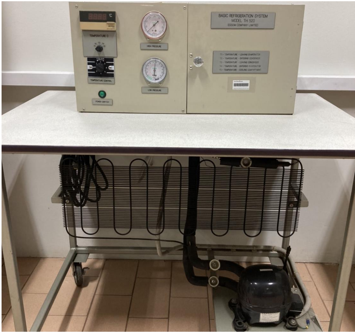
ชุดทดลอง Refrigeration System
