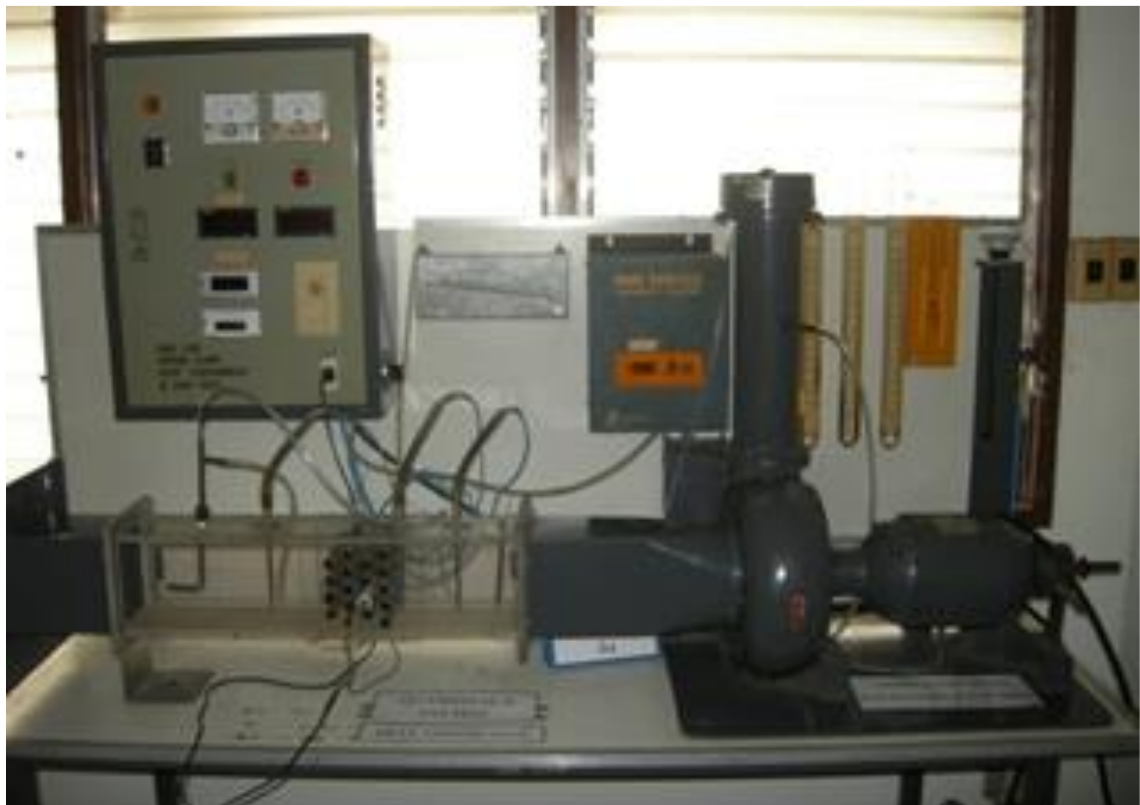
ชุดทดลองการส่งถ่ายความร้อนแบบไหลข้าม
