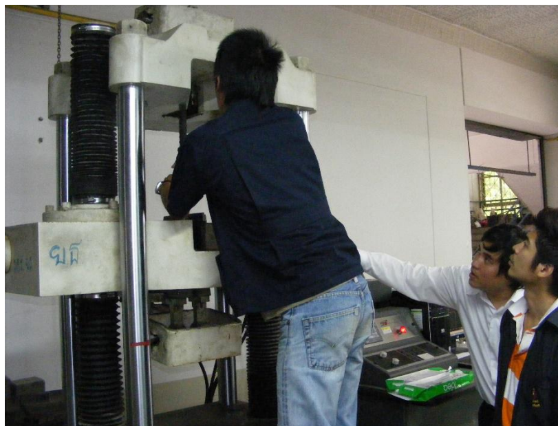
ชุดทดสอบแรงดึงของเหล็กเส้นชนิดกลมและเหล็กข้ออ้อย
