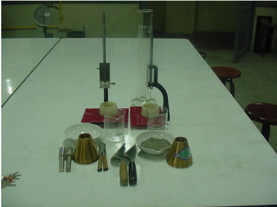
ชุดทดสอบการหาความชื้นเหลวปกติของปูนซีเมนต์ไฮดรอลิก
