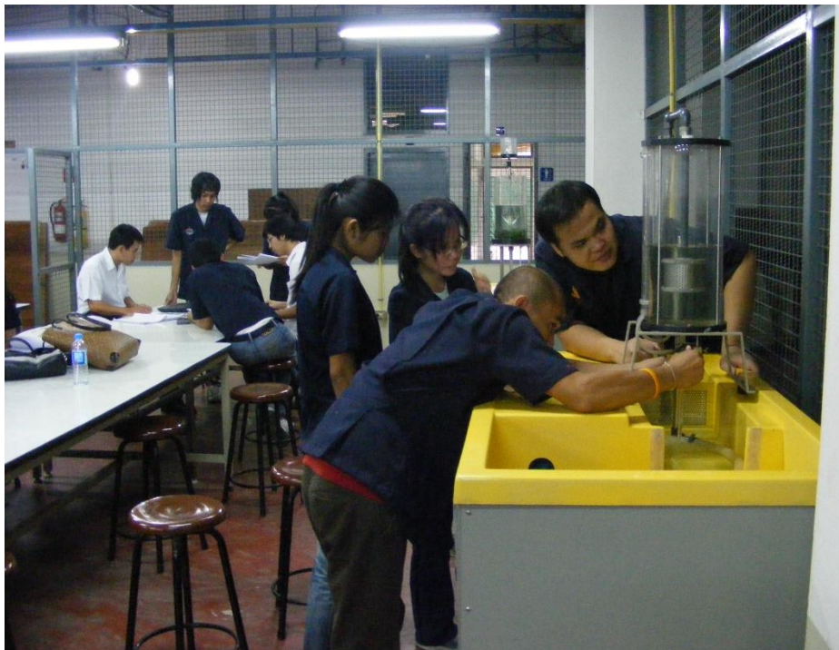
ชุดทดลองการไหลผ่านรูคอด (Flow Through an Orifice)
