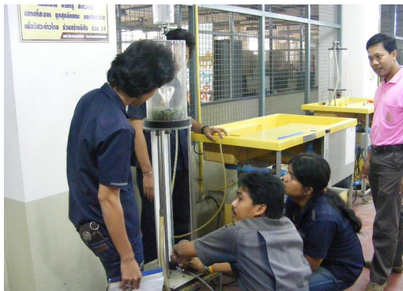
ชุดทดลองออสบอร์นเรย์โนลด์ (Osborne Reynolds Apparatus)
