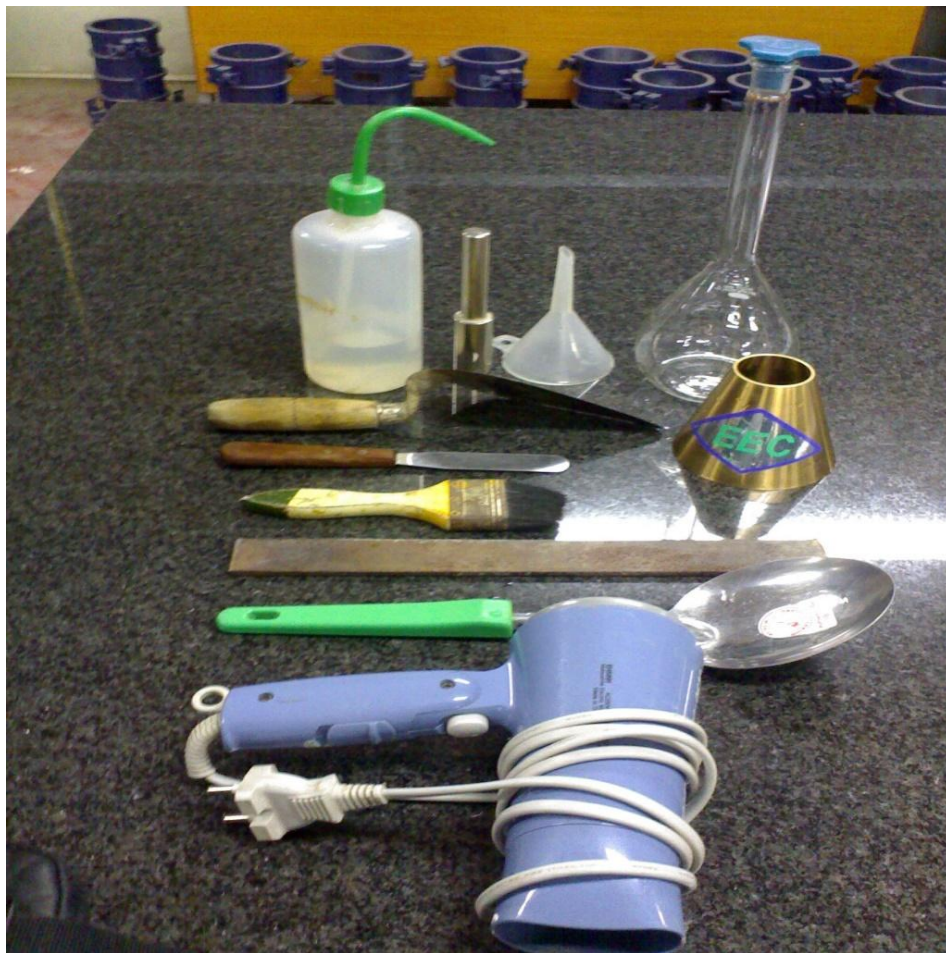
ชุดทดสอบการวิเคราะห์ความถ่วงจำเพาะและการดูดซึ่มของวัสดุผสมละเอียด
