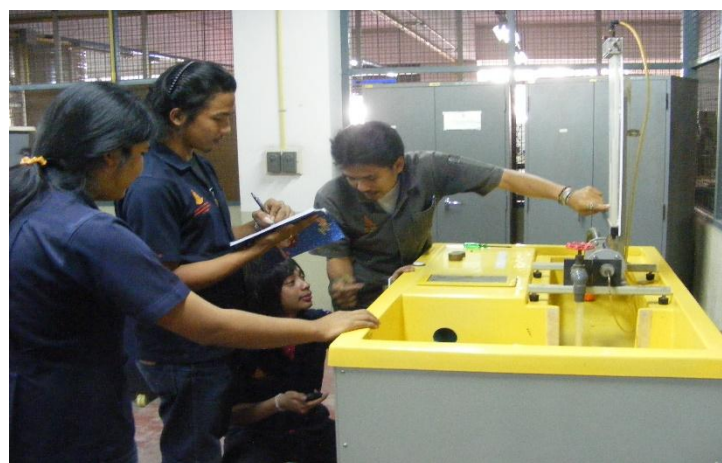
ชุดทดลองทฤษฎีของเบอร์นูลีและเวนจูรีมิเตอร์ (Bernoulli's Theorem and Venturi Meter)
