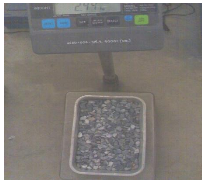
ชุดทดสอบการวิเคราะห์ความถ่วงจำเพาะและการดูดซึม ของวัสดุผสมหยาบ
