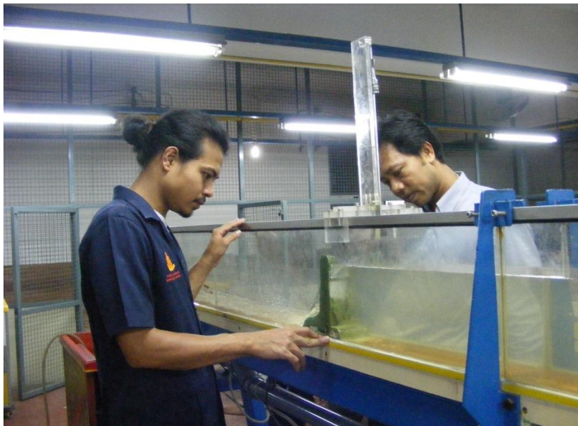
ชุดทดลองการไหลผ่านน้ช (Flow over Notch)
