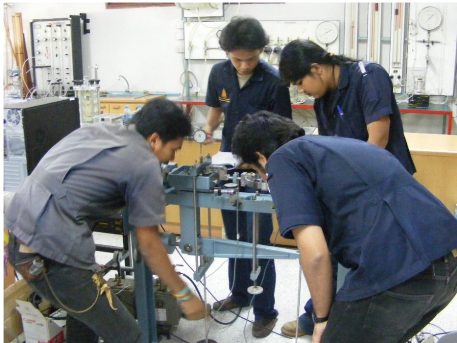
ชุดทดสอบ Direct Shear Test
