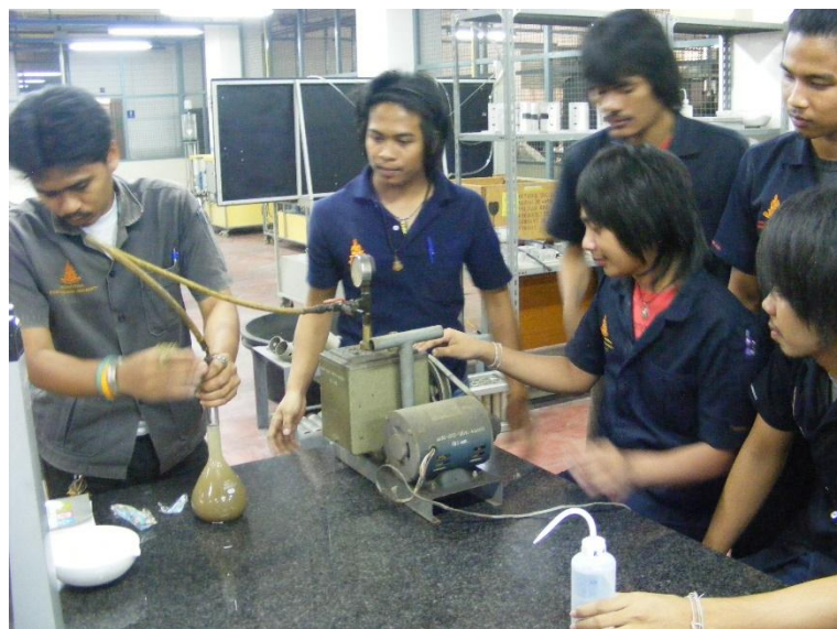
ชุดทดสอบหาค่าความถ่วงจำเพาะของเม็ดดิน
