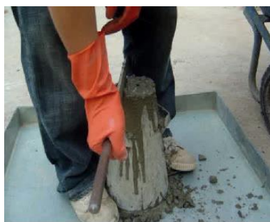
ชุดทดสอบการยุบตัวของคอนกรีต
