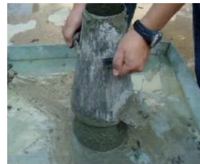
ชุดทดสอบการยุบตัวของคอนกรีต
