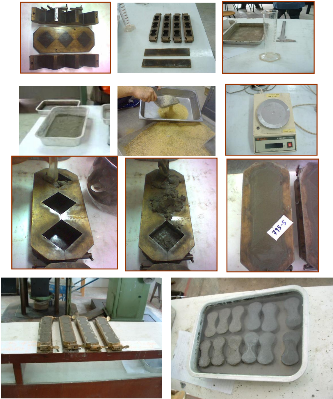
ชุดทดสอบกำลังรับแรงอัดและแรงดึงของซีเมนต์มอร์ต้า
