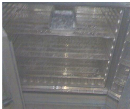
ชุดทดสอบการวิเคราะห์ความถ่วงจำเพาะและการดูดซึม ของวัสดุผสมหยาบ
