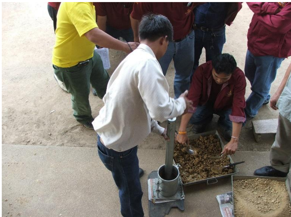
ชุดทดสอบการการบดอัดดินแบบมาตรฐานและแบบสูงกว่ามาตรฐาน
