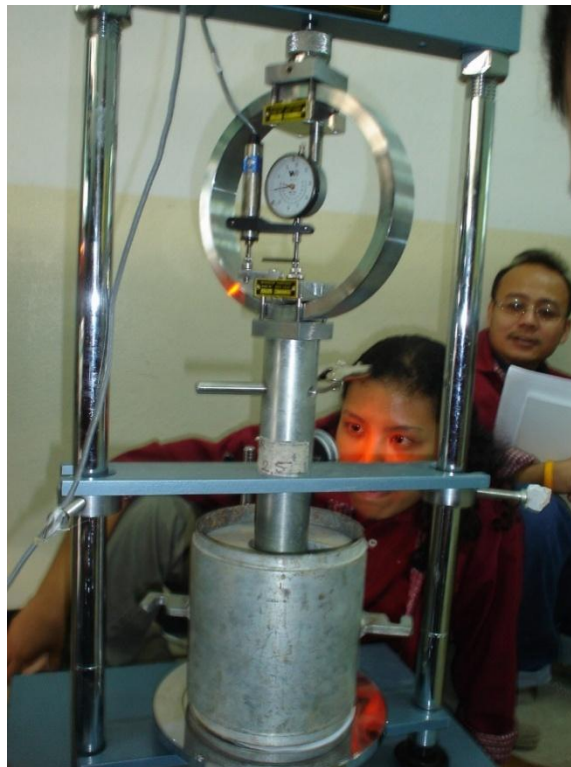
เครื่องมือประจำห้องปฏิบัติการปฐพีกลศาสตร์ ชุดทดสอบแคลิฟอร์เนียแบร์ริงเรโซ ( C.B.R. )
