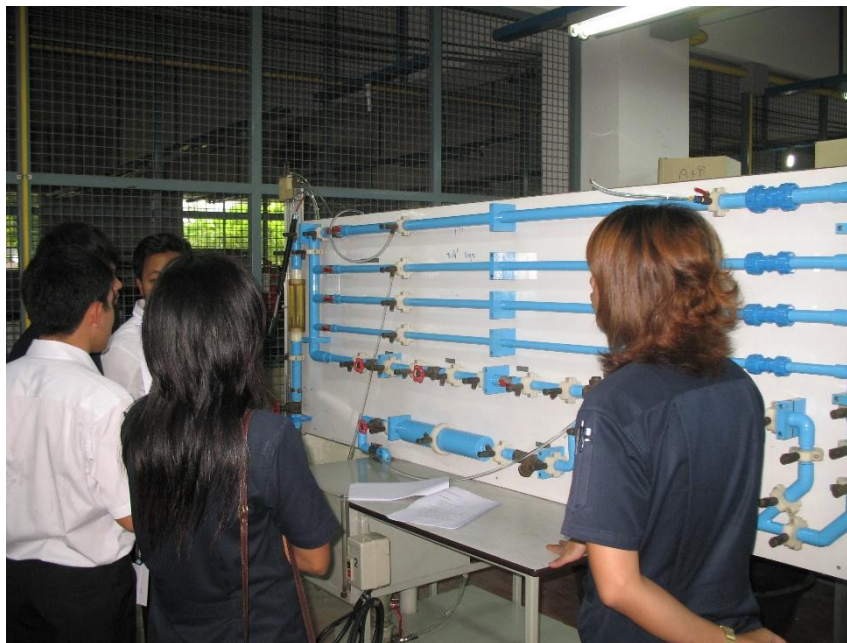
ชุดทดลองการสูญเสียในท่อ (Loss in Pipes)
