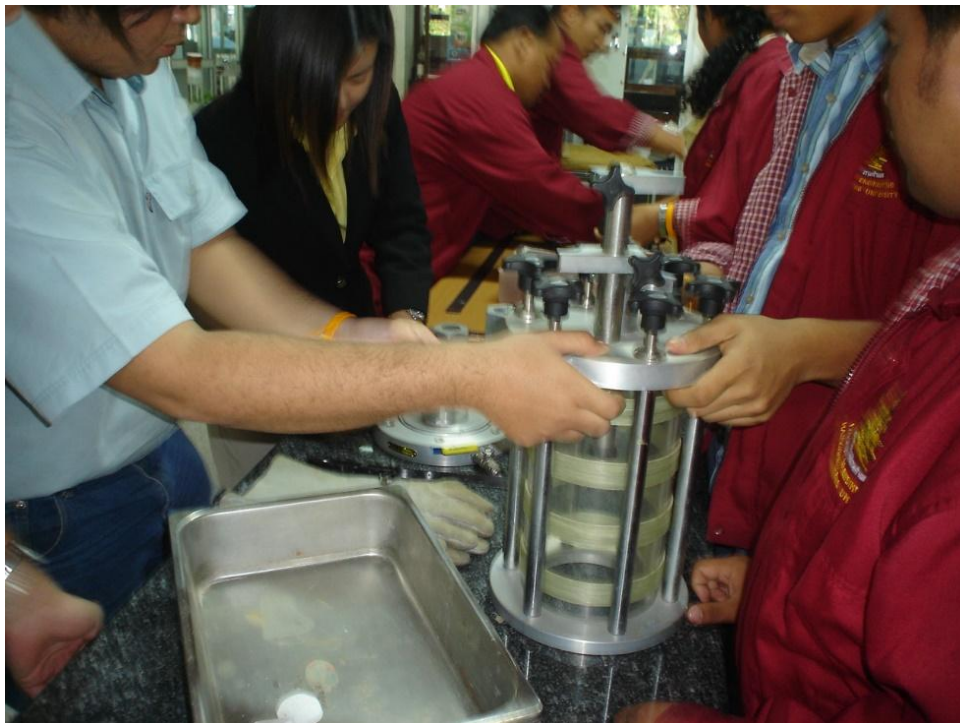
ชุดทดสอบ Triaxial Test
