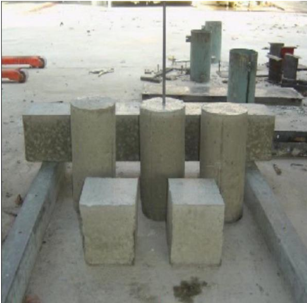
ชุดทดสอบกำลังรับแรงอัดและแรงดึงของคอนกรีต
