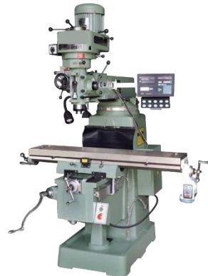
Vertical Milling Machine (SAMSON: S-4M) จำนวน 1 เครื่อง
