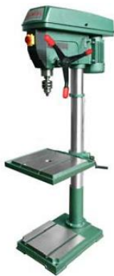
Drilling Machine (OKURA: YD-32P) จำนวน 1 เครื่อง
