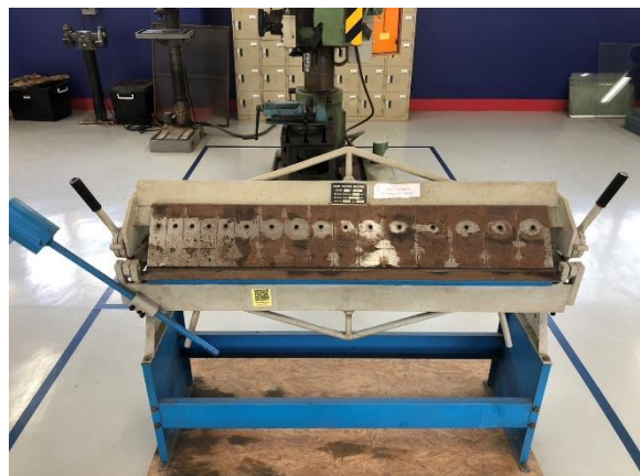
เครื่องพับโลหะแผ่น จำนวน 2 เครื่อง
