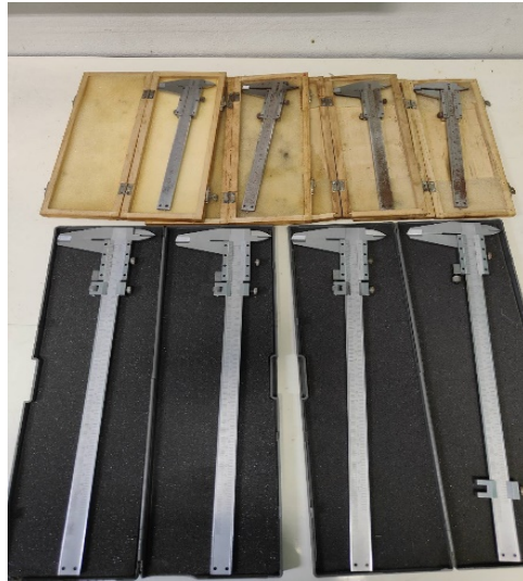
รูปที่ 6 เครื่องมือวัด เวอร์เนียคาลิปเปอร์ (Vernier Calipers) ห้อง ETB.101
