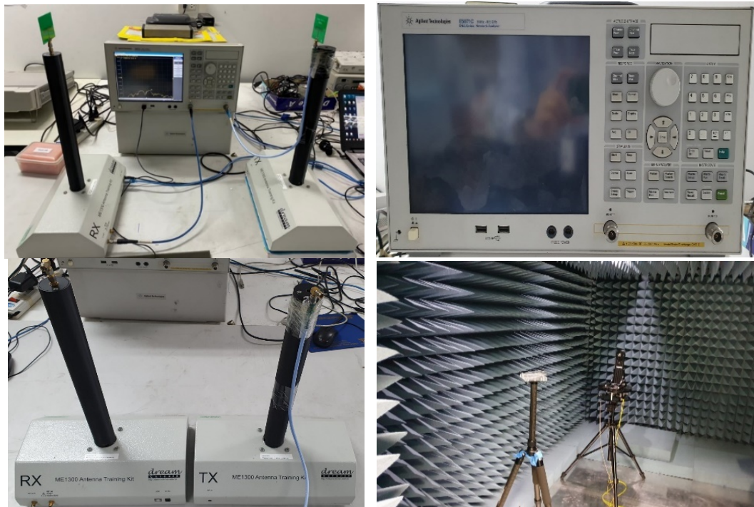
รูปที่ 41 ชุดหมุนสายอากาศขนาดเล็ก เครื่องวิเคราะห์โครงข่าย และชุดหมุนสายอากาศขนาดใหญ่
