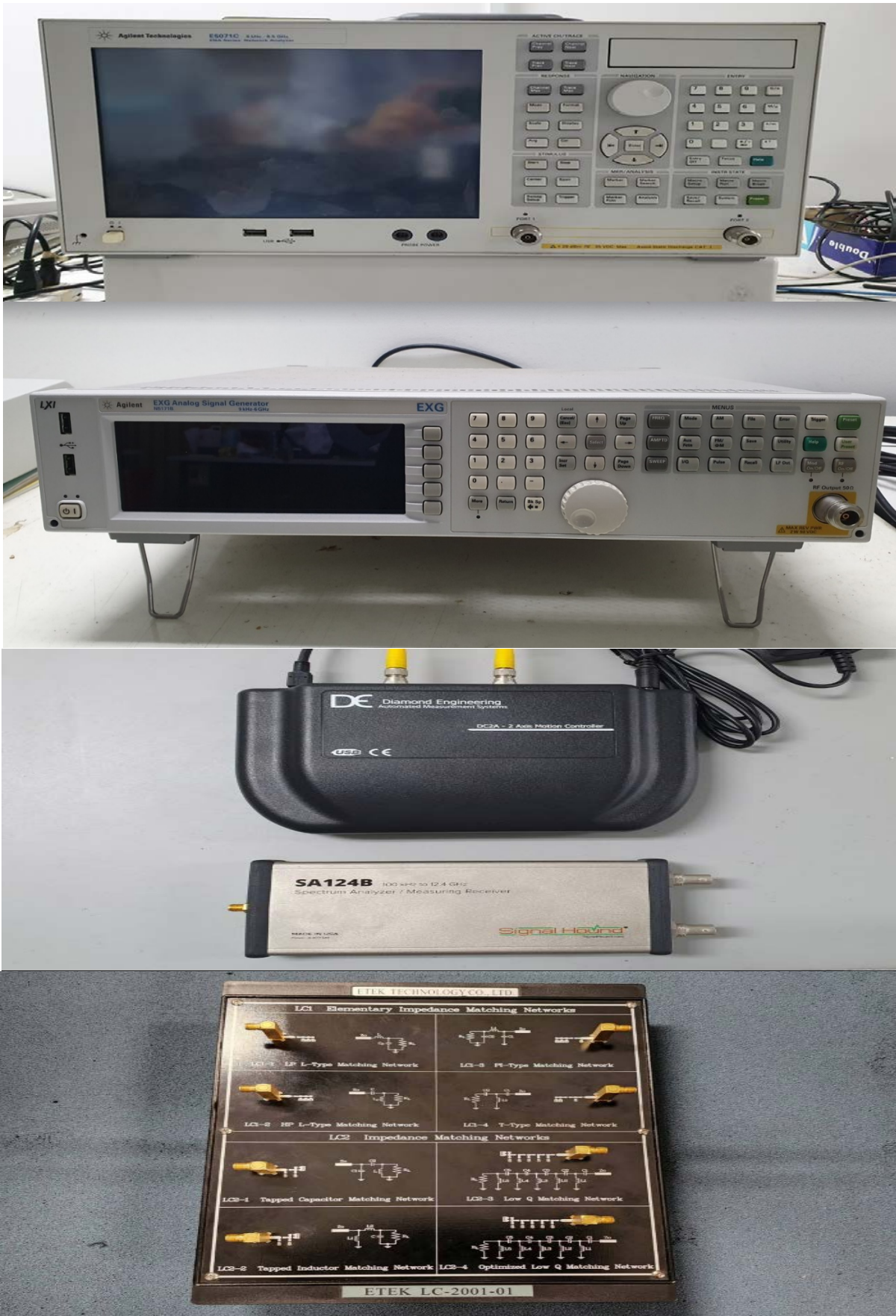
รูปที่ 29 ชุดเครื่องวิเคราะห์สเปกตรัม เครื่องวิเคราะห์โครงข่ายและวงจรแมตซ์อิมพีแดนซ์เบื้องต้น
