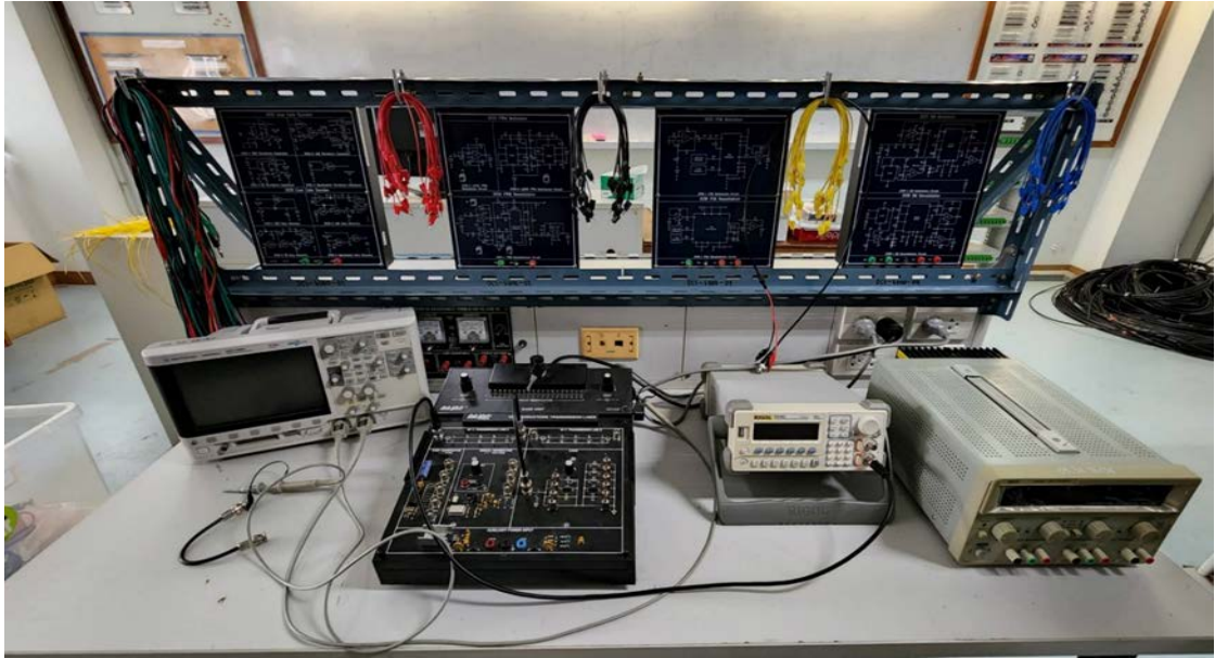
รูปที่ 35 ชุดตรวจวัดความเร็วและพฤติกรรมสายส่งสัญญาณเมื่อต่อโหลดแบบเชิงซ้อน
