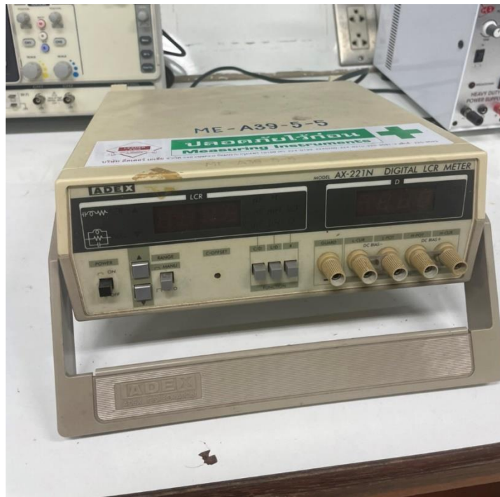
เครื่องวัดค่าความต้านทาน ความเหนี่ยวนำและความจุไฟฟ้า แบบดิจิทัล
