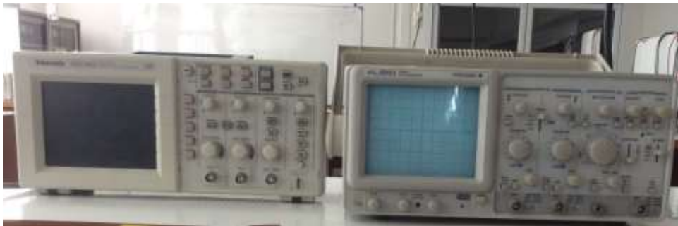
รูปที่ 3 เครื่องมือวัดรูปคลื่นไฟฟ้า
