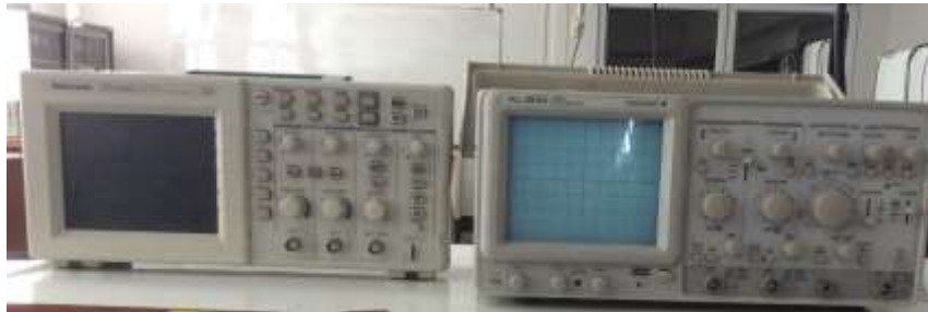
รูปที่ 39 เครื่องมือวัดรูปคลื่นไฟฟ้า
