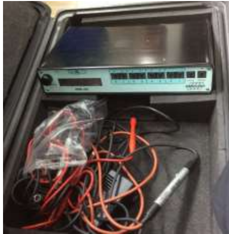
รูปที่ 49 อุปกรณ์การวัดการต่อลงดินแบบต่างๆ
