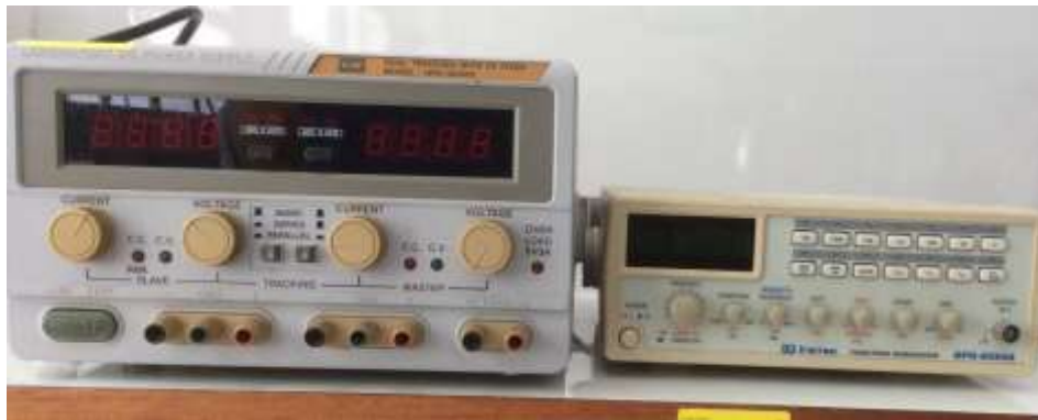
รูปที่ 1 อุปกรณ์จ่ายไฟฟ้ากระแสตรงและไฟฟ้ารูปคลื่นสัญญาณต่างๆ
