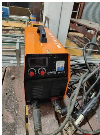
รูปที่ 2 เครื่องเชื่อมไฟฟ้า ห้อง ETB.101
