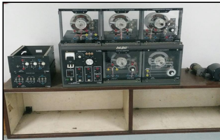
รูปที่ 27 ชุดปฏิบัติการเครื่องจักรกลไฟฟ้า
