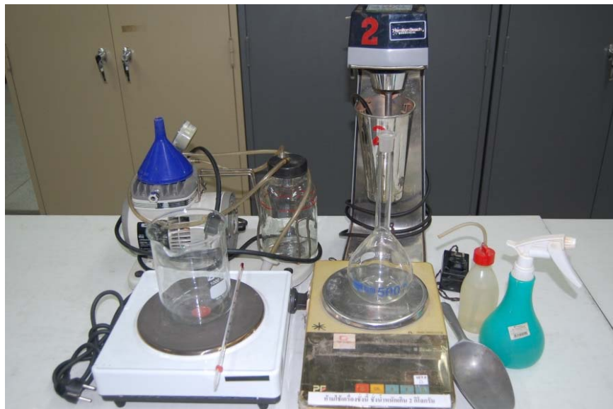
รูปที่ 5.1-37 ชุดทดสอบการหาค่าความถ่วงจำเพาะของเม็ดดิน
