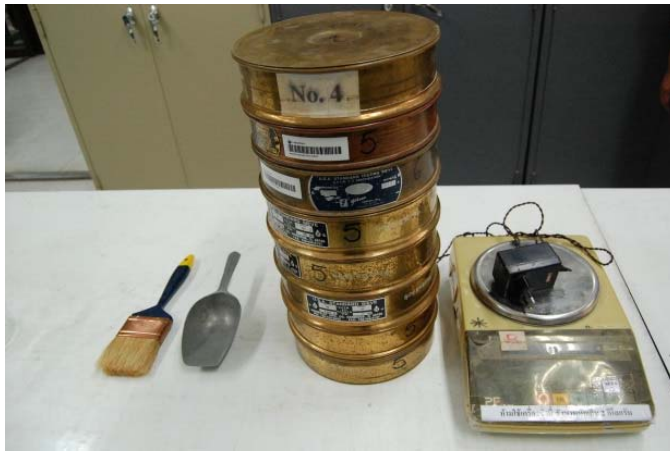
รูปที่ 5.1-39 ชุดทดสอบการจำแนกขนาดของเม็ดดินโดยวิธีใช้ตะแกรงร่อน
