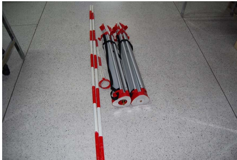
รูปที่ 5.1-70 อุปกรณ์เสริมต่างๆ ได้แก่ ขากล้อง, Staff, Pole, Pin
