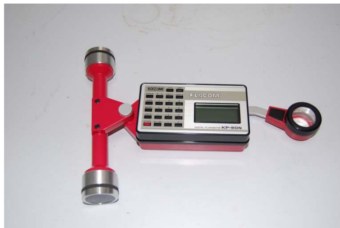
รูปที่ 5.1-71 เครื่องวัดพื้นที่จากรูปแผนที่
