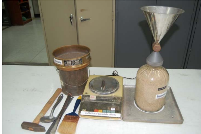
รูปที่ 5.1-43 ชุดทดสอบการหาค่าความหนาแน่นของดินในสนาม
