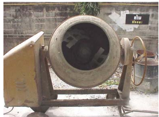
รูปที่ 5.1-20 เครื่องผสมคอนกรีต
