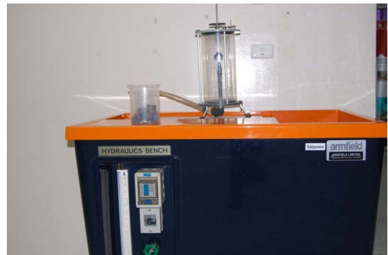
รูปที่ 5.1-54 ชุดทดลองแรงกระทบจากลำของไหล
