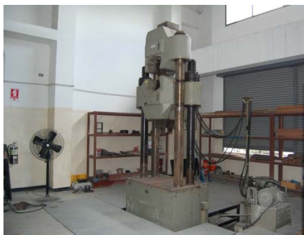
รูปที่ 5.1-3 เครื่องทดสอบ Universal Testing Machine ขนาด 200 ton
