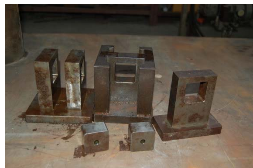
รูปที่ 5.1-6 ชุดทดสอบกำลังรับแรงเฉือนตรงของเหล็ก
