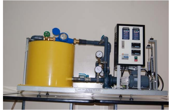
รูปที่ 5.1-58 ชุดทดสอบปั้มน้ำแบบแรงเหวี่ยงต่อแบบอนุกรมและขนาน
