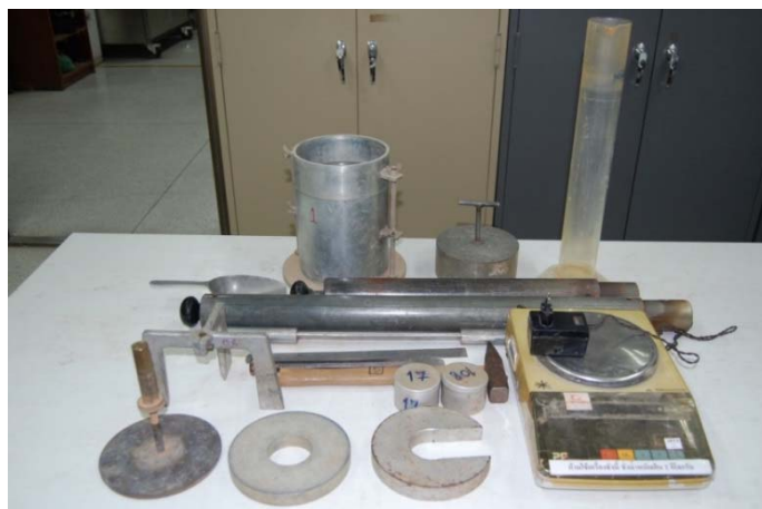
รูปที่ 5.1-42 ชุดทดสอบแคลิฟอร์เนียแบร์ริงเรโซ (C.B.R.)
