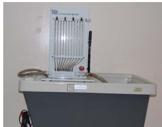
รูปที่ 5.1-56 ชุดทดลองมาตรวัดอัตราการไหลในท่อ
