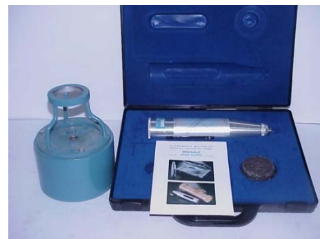
รูปที่ 5.1-4 เครื่องทดสอบคอนกรีตแบบไม่ทำลายแบบ Schmidt Hammer
