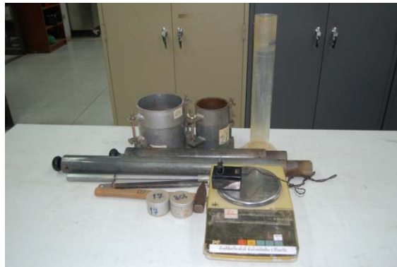
รูปที่ 5.1-41 ชุดทดสอบการบดอัดดินแบบมาตรฐานและแบบสูงกว่ามาตรฐาน
