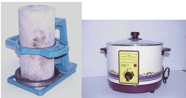
รูปที่ 5.1-27 ชุดเคลื่อนย้ายทดสอบและเตาต้มวัสดุ เคลื่อนย้ายทดสอบ
