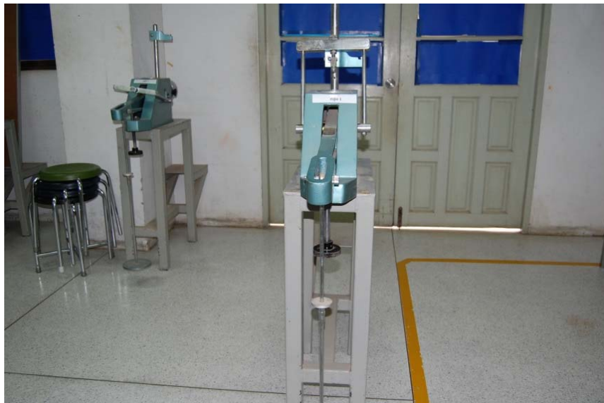
รูปที่ 5.1-48 ชุดทดสอบ Consolidation Test
