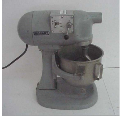
รูปที่ 5.1-13 เครื่องผสมซีเมนต์มอร์ต้าร์
