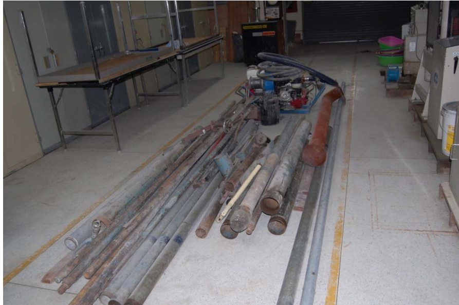
รูปที่ 5.1-36 เครื่องมือเจาะสำรวจดิน
