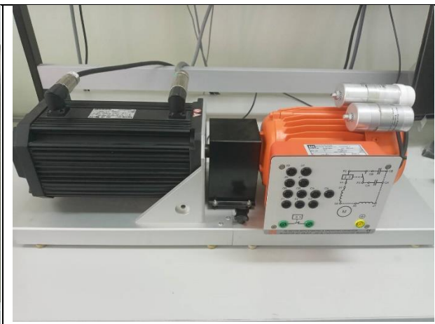
ชุดเบรคโหลดมอเตอร์พร้อมชุดอินเวอร์เตอร์ควบคุมแรงบิด และความเร็วรอบ
