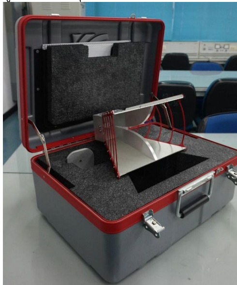
รูปที่ 5.10 จ สายอากาศมาตรฐาน
