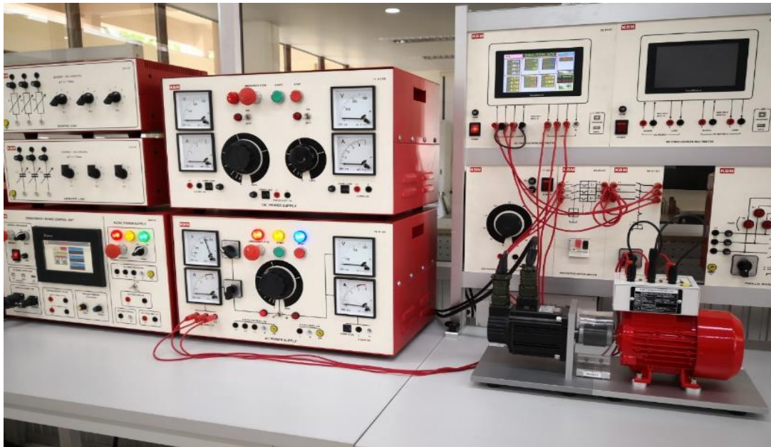
รูปที่ 4.24 ชุดทดลองมอเตอร์ไฟฟ้าเหนี่ยวนำ 3 เฟส แบบโรเตอร์กรงกระรอก
