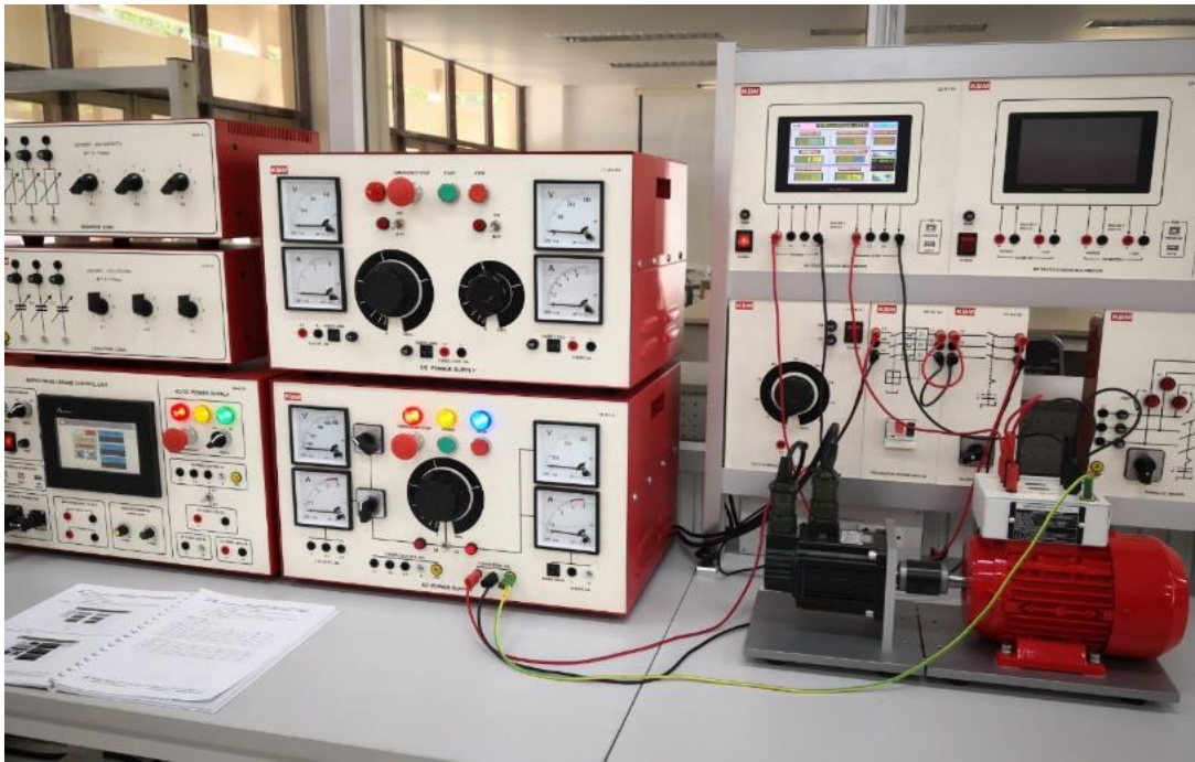
รูปที่ 4.26 ชุดทดลองมอเตอร์ไฟฟ้าเหนี่ยวนำ 1 เฟส ชนิด Capacitor Run
