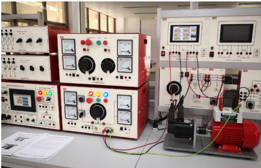
รูปที่ 4.27 ชุดทดลองมอเตอร์ไฟฟ้าเหนี่ยวนำ 1 เฟส ชนิด Split Phase
