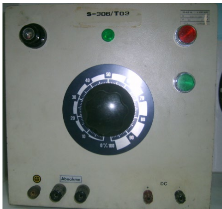
อุปกรณ์ปรับค่าแรงดันไฟฟ้าตรง สลับชนิด 1 เฟส
