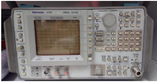
Spectrum Analyzer ความถี่ 10 kHz – 21 GHz
