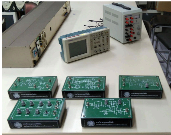
ชุดทดลองสำหรับฝึกปฏิบัติการโทรคมนาคม (AM, FM, และ PWM.)
