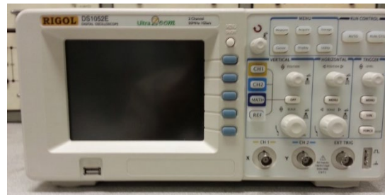
Digital Oscilloscope DS1052E 50MHz
