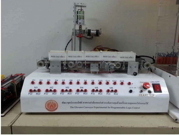
ชุดประลองลิฟท์สายพานลำเลียง
