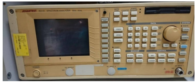
Spectrum Analyzer ความถี่ 9 kHz – 3 GHz
