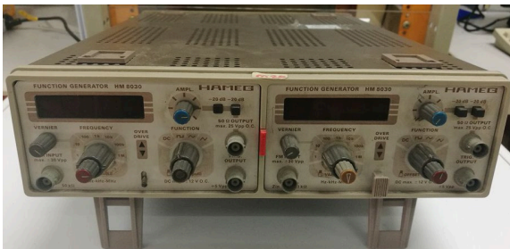
Signal Generator ความถี่ 1 Hz -1 MHz
