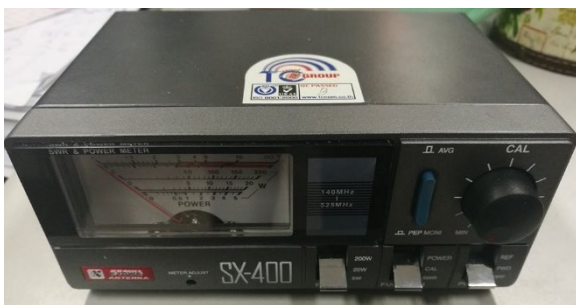
RF Wattmeter SX-400 และ SX-200 ความถี่ 1.8 MHz – 525 MHz
