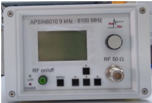
Signal Generator ความถี่ 9 kHz – 6.1 GHz
