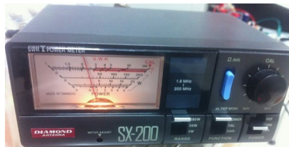
RF Wattmeter SX-400 และ SX-200 ความถี่ 1.8 MHz – 525 MHz
