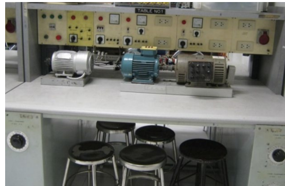
อุปกรณ์ปรับค่าแรงดันไฟฟ้าชนิด 1 เฟส และ 3 เฟส
