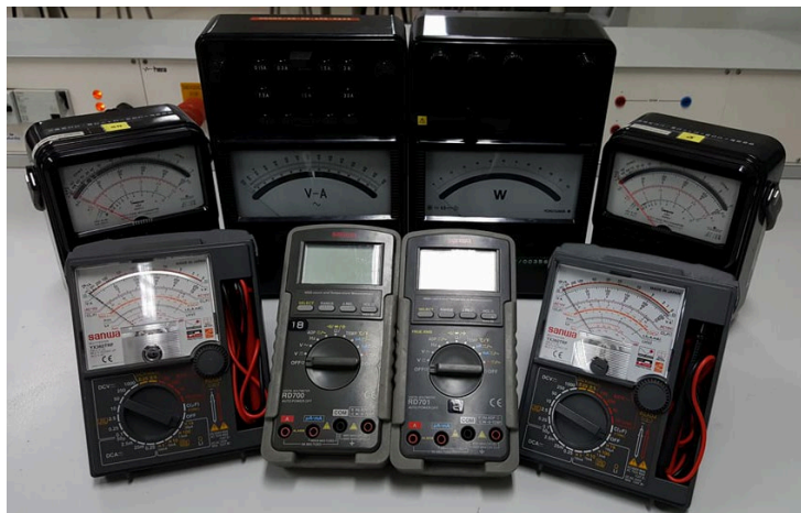
เครื่องมือวัดแรงดัน กระแส และกำลังไฟฟ้าขนาดต่าง ๆ
