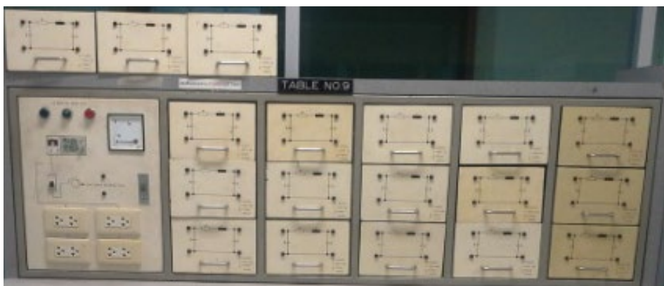
ชุดทดลองระบบสายส่ง
