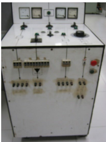
อุปกรณ์ปรับค่าแรงดันไฟฟ้าชนิด 1 เฟส และ 3 เฟส
