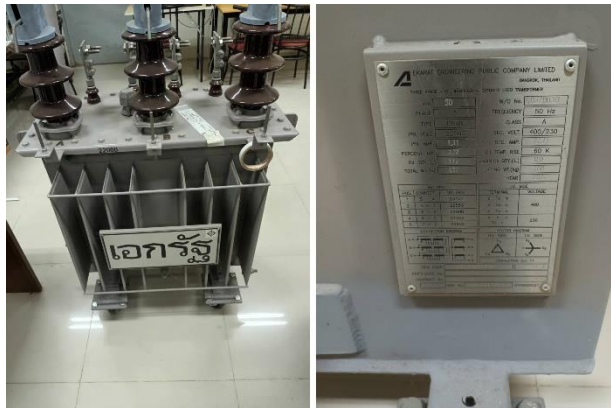
หม้อแปลงไฟฟ้าสามเฟส 50 KV, 50Hz, 22,000-400/230V
