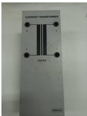
หม้อแปลงกระแสไฟฟ้า
