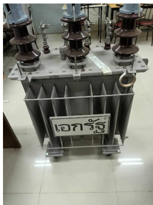
หม้อแปลงไฟฟ้าสามเฟส 50 kV, 50Hz, 22,000-400/230V
