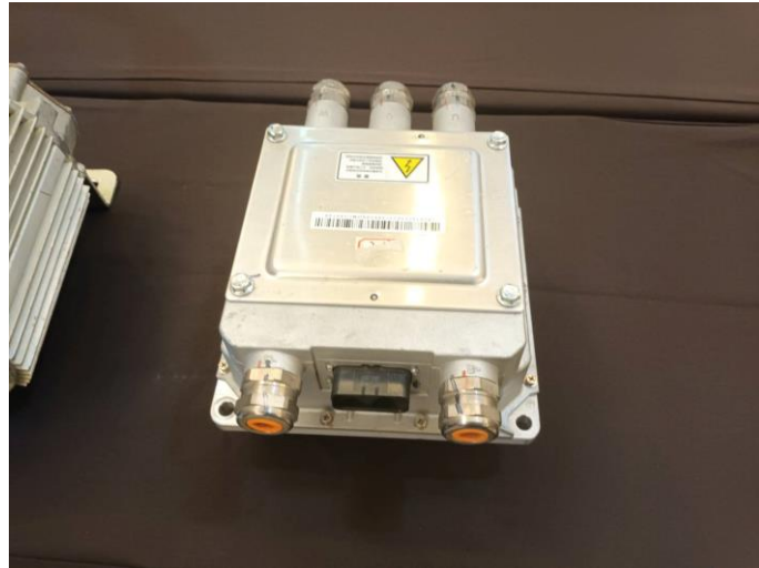
อินเวอร์เตอร์ขับเคลื่อนมอเตอร์ซิงโครนัสสามเฟสแบบแม่เหล็กถาวร (สำหรับ EV)
