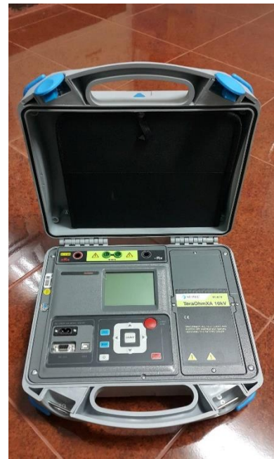
เครื่องทดสอบฉนวนงานไฟฟ้าแรงสูง 10 kV
