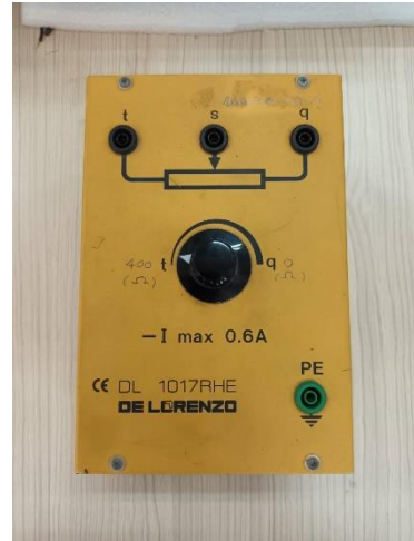
ความต้านทานปรับค่าได้ สำหรับปรับกระแสสร้างสนามแม่เหล็ก
