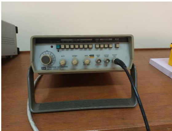
เครื่องกำเนิดสัญญาณ
