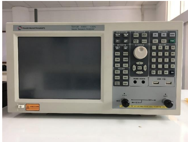
เครื่อง Network Analyzer
