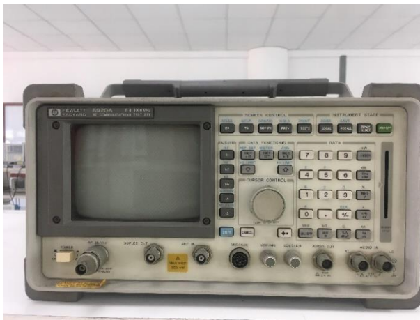
เครื่อง RF Communications test set
