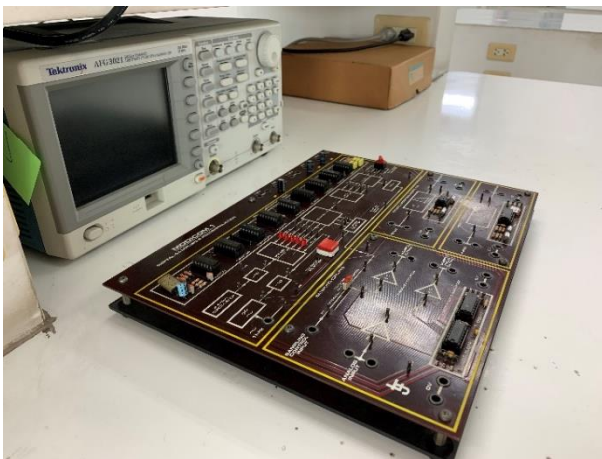
ชุดทดลอง Signal Sampling & Reconstruction
