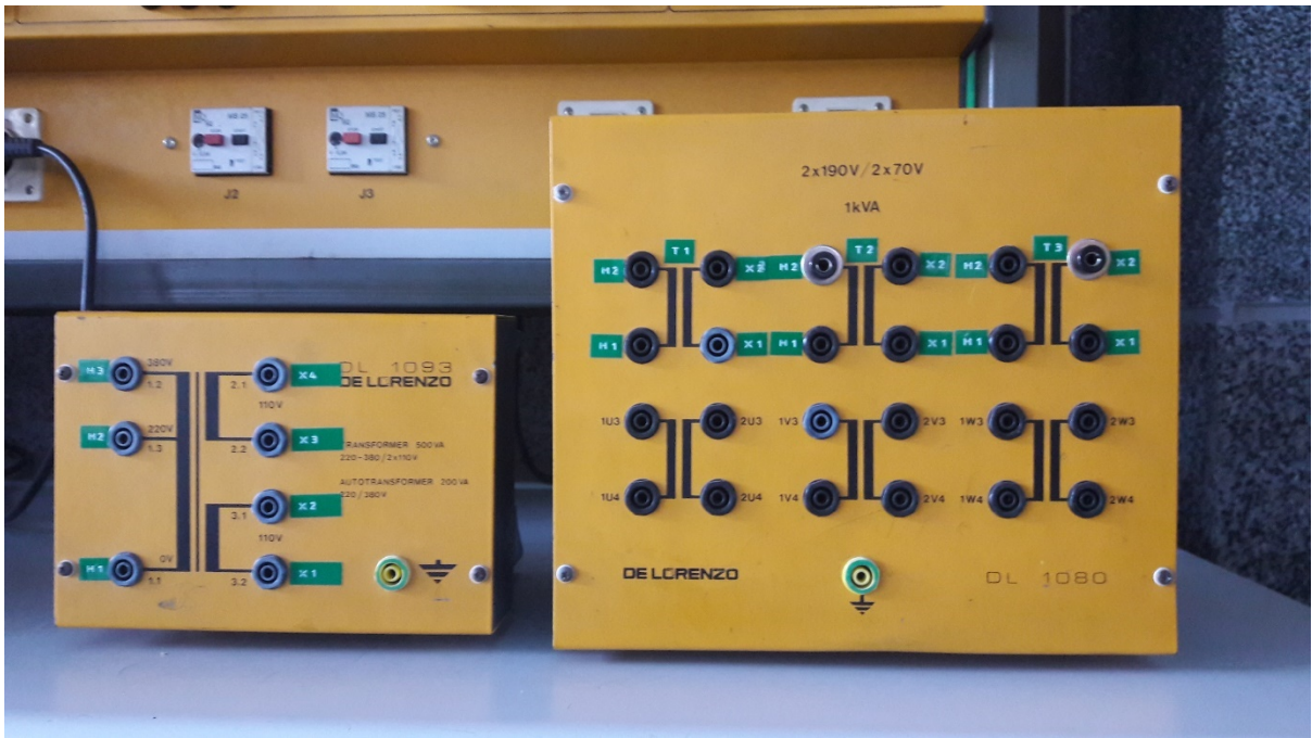
ชุดทดลองหม้อแปลงไฟฟ้า
