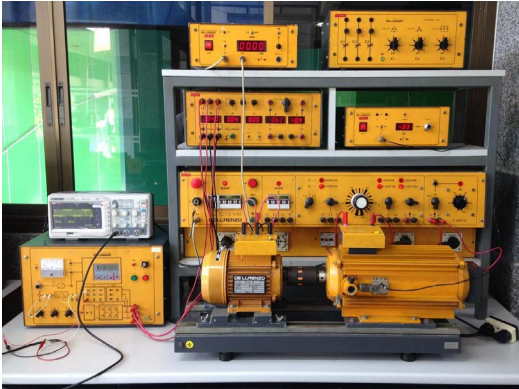
ชุดทดลองการควบคุมความเร็วรอบมอเตอร์เหนี่ยวนำสามเฟส
