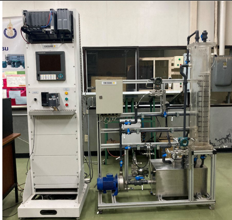
ชุดทดลองระบบ DCS
