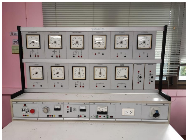
รูปที่ 16 ชุดปฏิบัติการ Voltmeter Ammeter Ohmmeter Wattmeter
