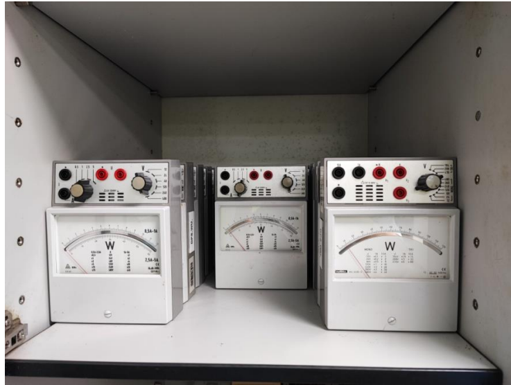
รูปที่ 42 Single Phase and 3 Phase Power Meter 1 เฟส และ 3 เฟส
