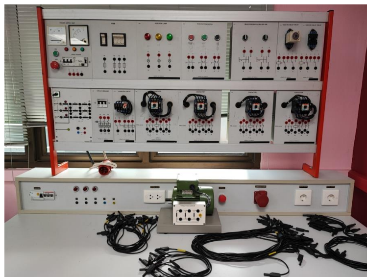
รูปที่ 33 ชุดปฏิบัติการควบคุมมอเตอร์ด้วย Magnetic Contactor
