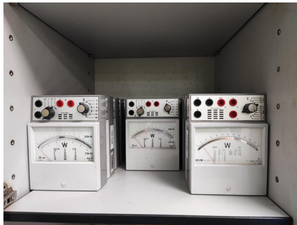
รูปที่ 11 Single phase and 3 phase Power meter 1 เฟส และ 3 เฟส
