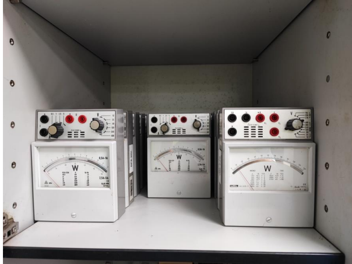
รูปที่ 31 Single phase and 3 phase Power meter 1 เฟส และ 3 เฟส
