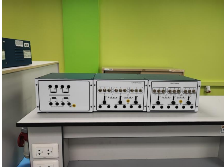
รูปที่ 39 หม้อแปลงไฟฟ้า 1 เฟส
