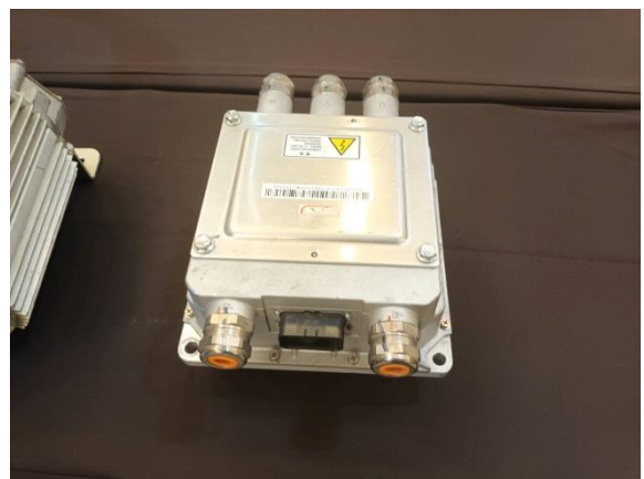
อินเวอร์เตอร์ขับมอเตอร์ไฟฟ้าซิงโครนัสแบบ แม่เหล็กถาวร (PMSM Inverter)
