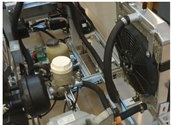
คอมเพรสเซอร์ไฟฟ้า และระบบระบายความร้อน
