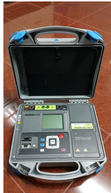
เครื่องทดสอบฉนวนงานไฟฟ้าแรงสูง 10 kV
