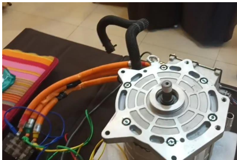
มอเตอร์ไฟฟ้าซิงโครนัสสามเฟสแบบแม่เหล็กถาวร (PMSM) (สำหรับ EV)
