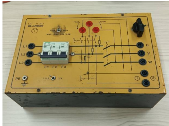
ชุดสวิตช์ขนานเครื่องกำเนิดไฟฟ้า ซิงโครนัสสามเฟส
