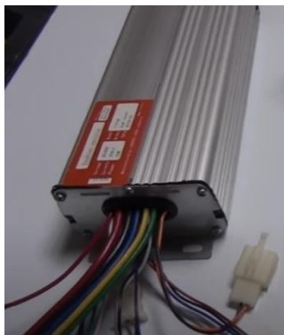
คอนเวอร์เตอร์ขับมอเตอร์ไฟฟ้ากระแสตรงแบบไร้แปรงถ่าน
