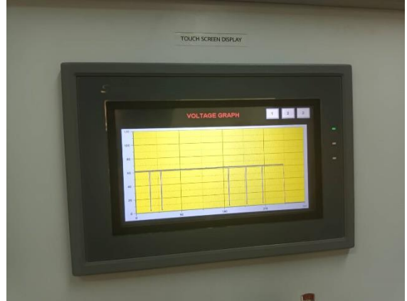
หน้าจอทัชสกรีนสำหรับแสดงกราฟ การอัดประจุและคายประจุ
