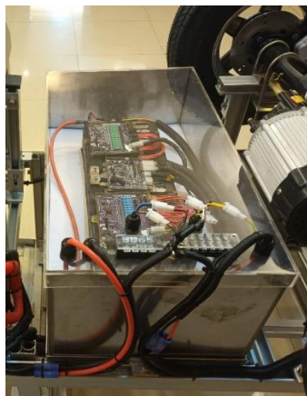
ระบบจัดการแบตเตอรี่ และชุดแบตเตอรี่ลิเทียมฟอสเฟต LFP
