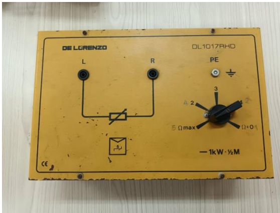
ความต้านทานปรับค่าได้ สำหรับปรับกระแสอาร์เมเจอร์
