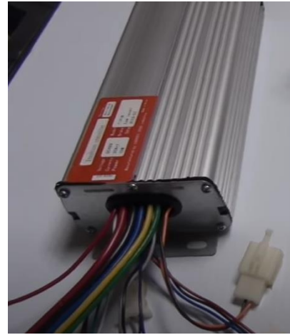
คอนเวอร์เตอร์ขับเคลื่อนมอเตอร์ไฟฟ้ากระแสตรง แบบไร้แปรงถ่าน
