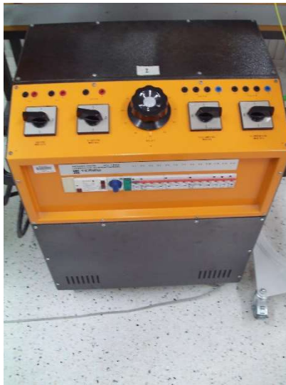
หม้อแปลงปรับค่าแรงดันไฟฟ้าชนิด 1 เฟส และ 3 เฟส
