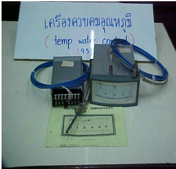
43) เครื่องควบคุมอุณหภูมิ
