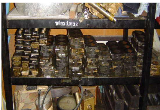
11) แบบหล่อคอนกรีต
