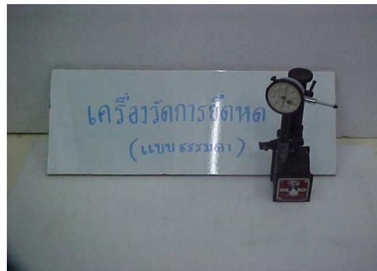
30) เครื่องวัดระยะการโก่งตัวพร้อมขาแม่เหล็ก
