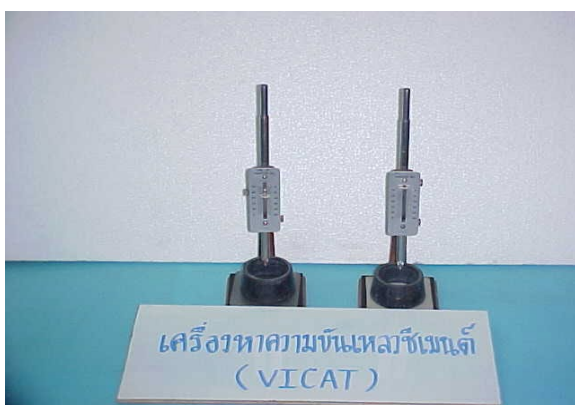
35) เครื่องทดสอบหาเวลาการก่อตัวของซีเมนต์
