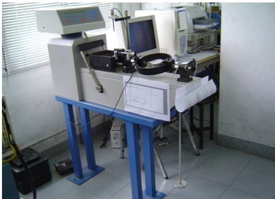
27) เครื่องมือทดสอบแรงเฉือนโดยตรงแบบดิจิทัล
