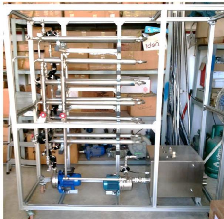
รูปที่ 1.8 ชุดทดลองการแลกเปลี่ยนความร้อนชนิดท่อสองชั้น
