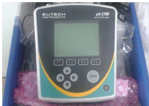
รูปที่ 1.10 เครื่องมือวัดความเป็นกรดเป็นด่าง
