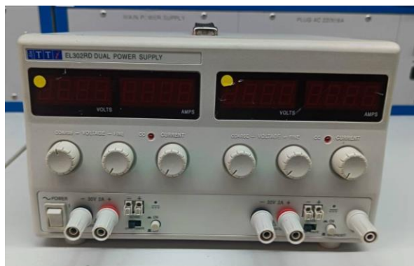
รูปที่ 1.20 อุปกรณ์แหล่งจ่ายไฟฟ้ากระแสตรง กระแสสลับ
