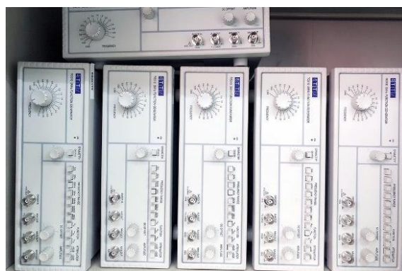
รูปที่ 1.21 อุปกรณ์แหล่งจ่ายรูปคลื่นสัญญาณไฟฟ้าต่างๆ
