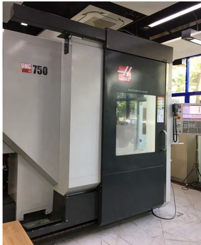
ภาพที่ 21 เครื่องจักรกลอัตโนมัติแบบควบคุมการทำงาน 5 แกน (Machining Center)
