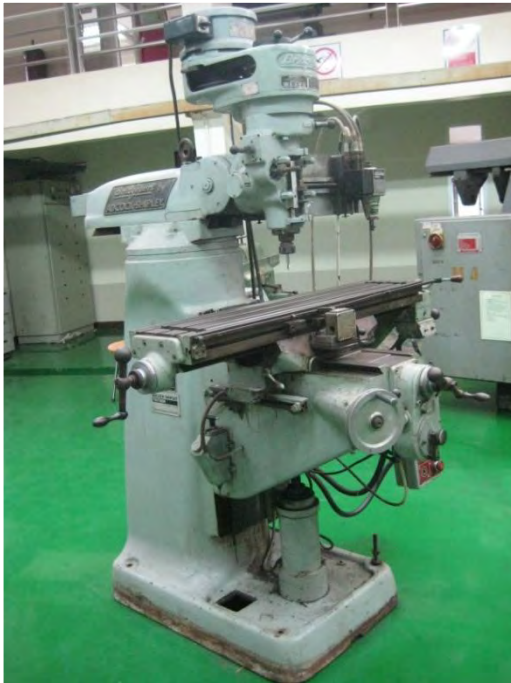
(ก) เครื่องกัดแนวตั้ง (Vertical Milling)
