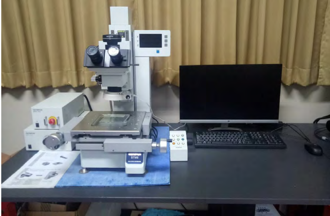
ภาพที่ 32 เครื่องวัดขนาดด้วยกล้องจุลทรรศน์ Measuring Microscope
