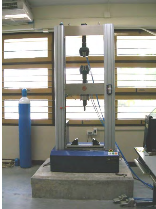
ภาพที่ 6 เครื่องทดสอบแรงทางกลแบบอเนกประสงค์ (Universal Testing Machine)
