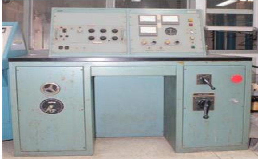
รูปที่ 25 โต๊ะควบคุม Control desk ชนิด combined control desk และวงจรการควบคุมของโต๊ะทดลองทั้งหมด
