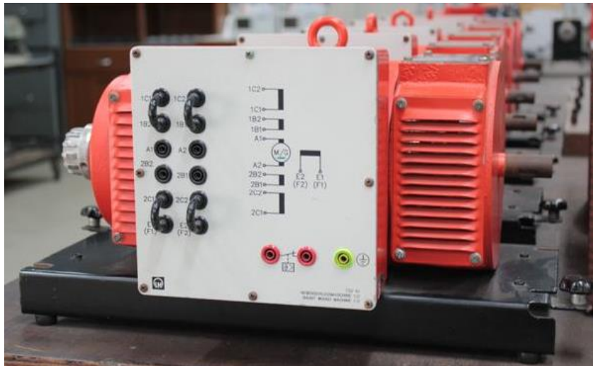
รูปที่ 20 เครื่องกำเนิดไฟฟ้ากระแสตรง
