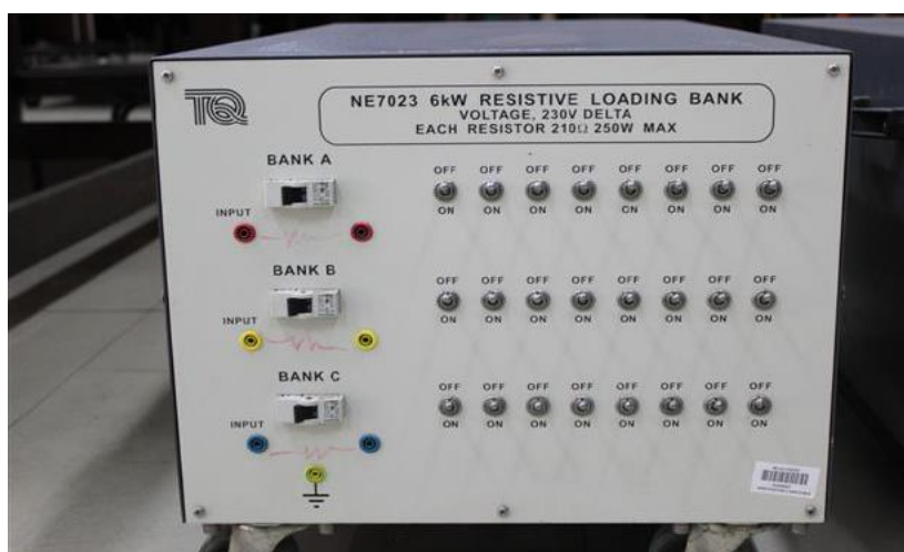
รูปที่ 5 6 kw แบงค์โหลดการะตัวต้านทาน
