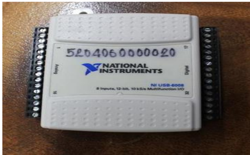
รูปที่ 10 อุปกรณ์ดักข้อมูลแอนะล็อก (DAQ)
