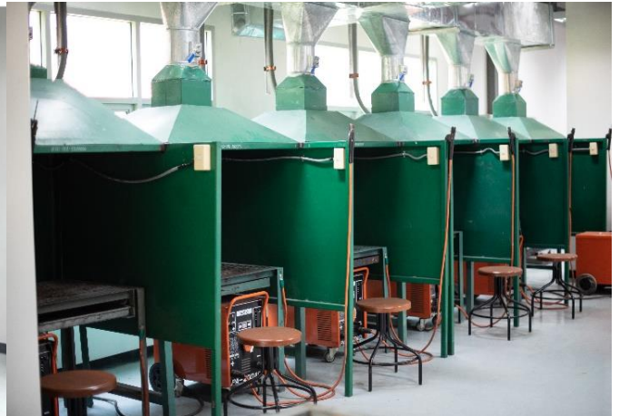
รูปที่ 6 สถานที่สำหรับงานเชื่อมไฟฟ้า (Electric Welding)
