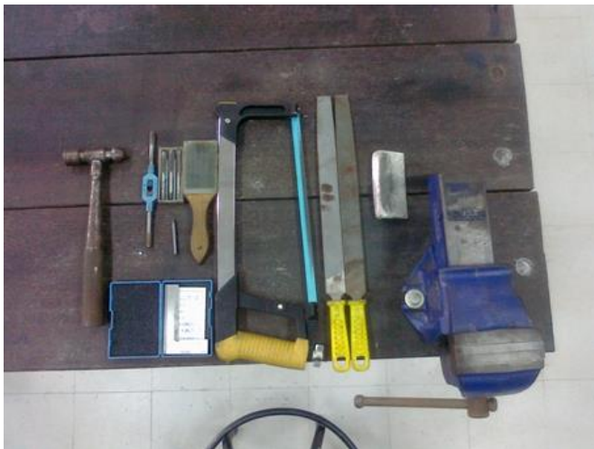
รูปที่ 3 เครื่องมือสำหรับงานตะไบ (Bench work)
