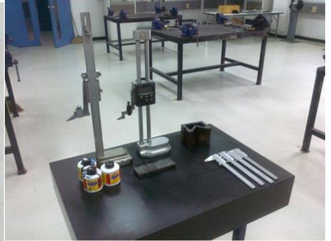
รูปที่ 4 เวอร์เนียร์คาลิปเปอร์ แบบต่างๆและโต๊ะหินแกรนิตระดับในห้องปฏิบัติการ
