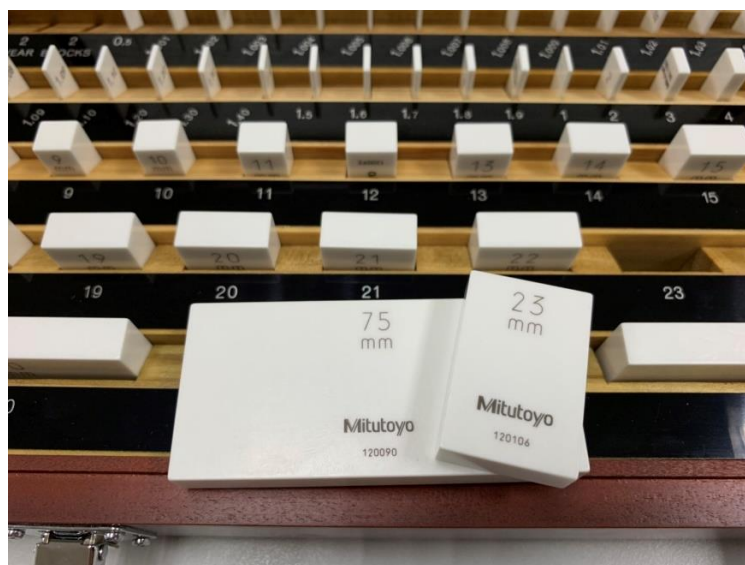
รูปที่ 9 ชุดอุปกรณ์เครื่องมือสำหรับมาตรวัด (Gauge Blocks)
