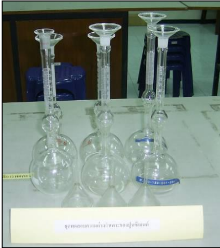
ชุดทดสอบหาค่าความถ่วงจำเพาะของปูนซีเมนต์
