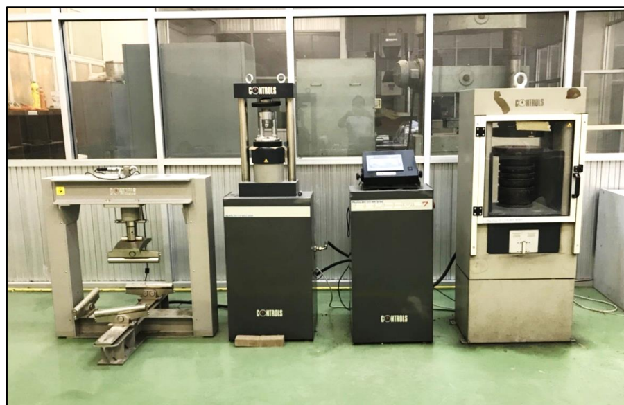
ชุดทดสอบกำลังอัดของคอนกรีต ขนาด 300 ตัน
