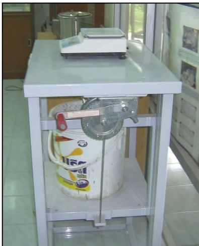
ชุดทดสอบหาค่าความถ่วงจำเพาะของมวลรวมหายาบ
