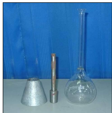
ชุดทดสอบหาค่าความถ่วงจำเพาะของมวลรวมละเอียด
