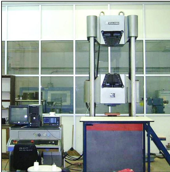
เครื่องทดสอบ Universal Testing Machine ขนาด 200 ตัน
