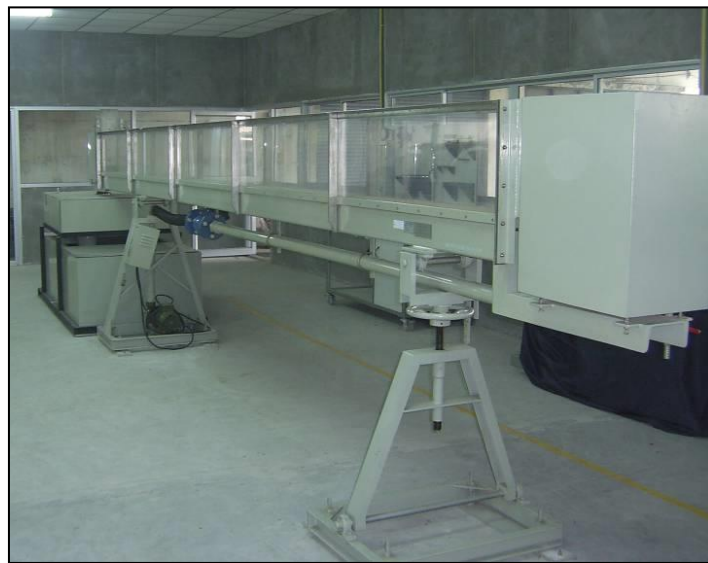
ชุดทดสอบรางน้ำเปิดกว้าง 0.15 ม. ยาว 6.00 ม.
