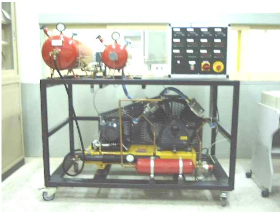
รูปที่ 4.70 Air Compressor Testing
