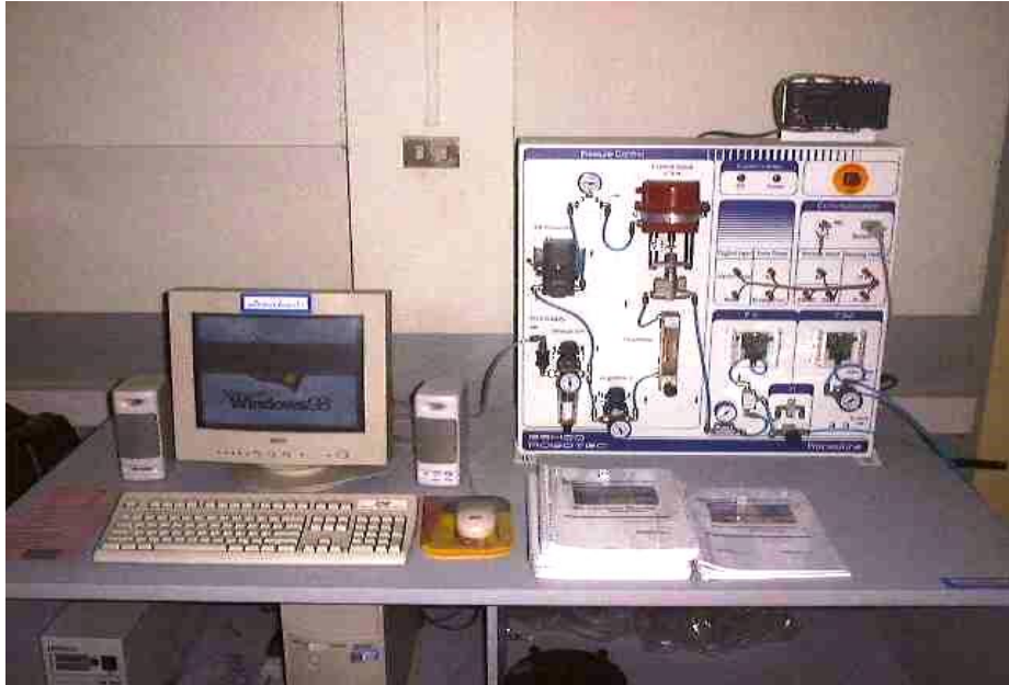
รูปที่ 4.79 Process Control 2 (Pressure Control)
