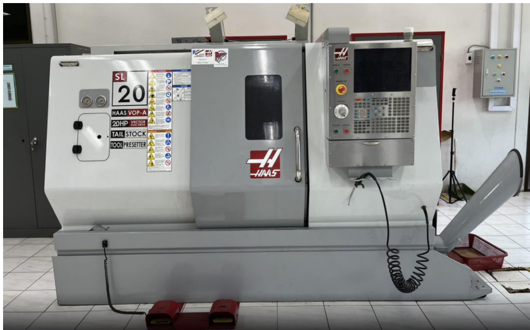
รูปที่ 4.46 เครื่องกลึงอัตโนมัติ CNC TURNING สำหรับงานอุตสาหกรรม
