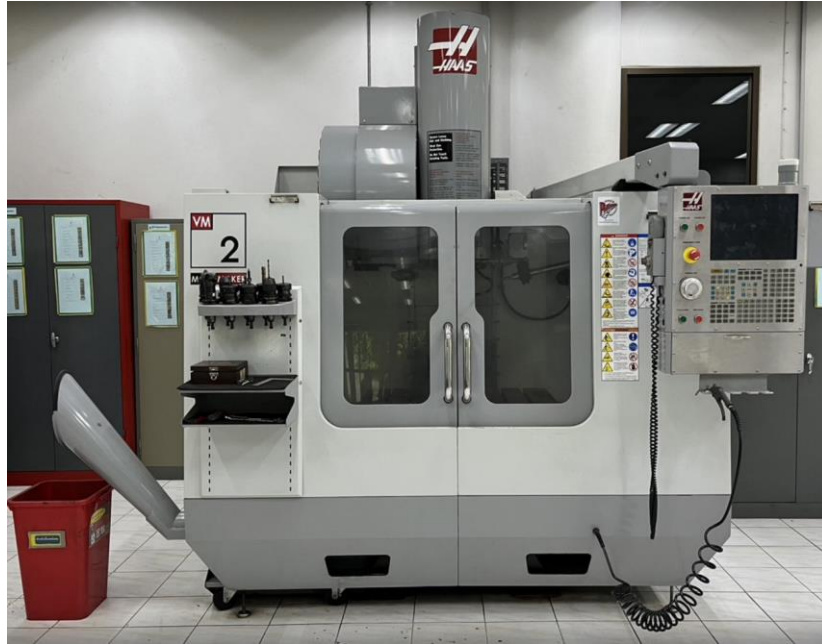
รูปที่ 4.45 เครื่องกัดอัตโนมัติ CNC MILLING สำหรับงานอุตสาหกรรม
