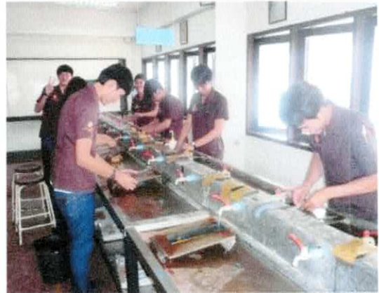
อุปกรณ์ขัดเตรียมชิ้นทดสอบโครงสร้างจุลภาค
