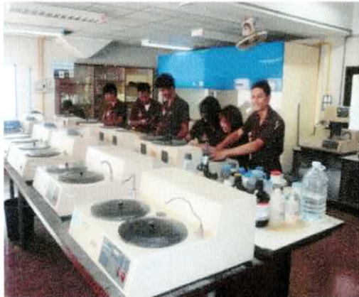
อุปกรณ์ขัดเตรียมชิ้นทดสอบโครงสร้างจุลภาค
