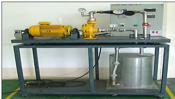
ภาพที่ 4.43 Centrifugal Pump Test Set
