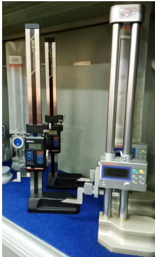
เครื่องวัดความสูงระบบดิจิทัล
