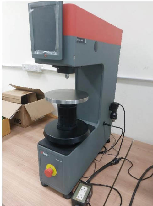
เครื่องทดสอบทดสอบความแข็ง (Hardness Test) แบบบริเนลล์
