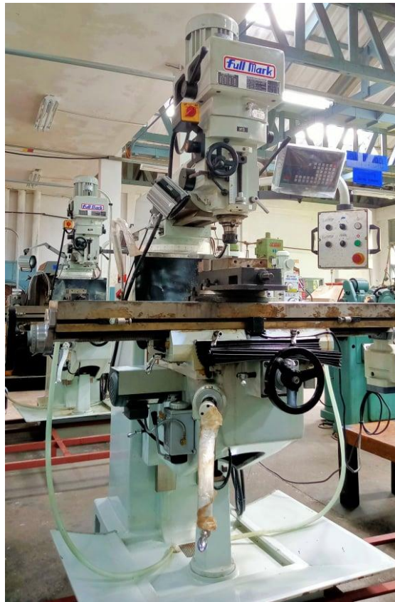
เครื่องกัดโลหะเพลาดิ่ง (Vertical Milling)
