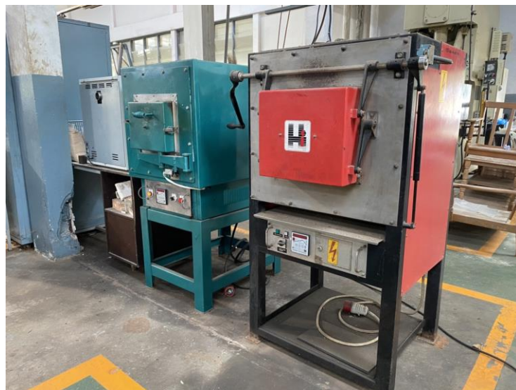
เตาอบโลหะแบบ ช่อง 1200 องศาเซลเซียส
