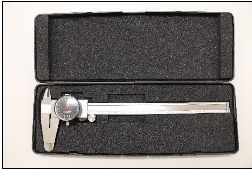
รูปที่ 14 เวอร์เนียคาร์ิปเปอร์แบบหน้าปิด
