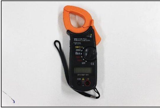
รูปที่ 97 แคลมป์มิเตอร์
