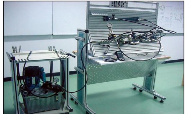
รูปที่ 72 ชุดการทดลอง Hydraulic lab
