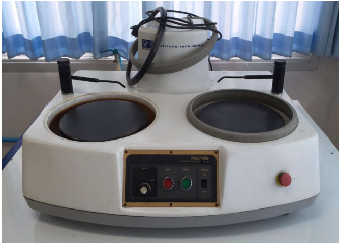
เครื่องขัดกระดาษทราย (Grinding & Polishing)
