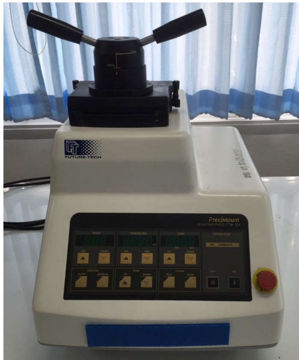
เครื่องขึ้นตัวเรือนชิ้นงาน (Hot Mounting)
