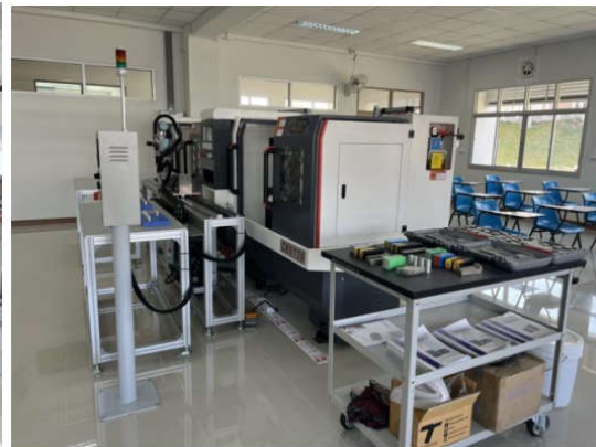
เครื่อง CNC และชุดแขนกลอัตโนมัติ
