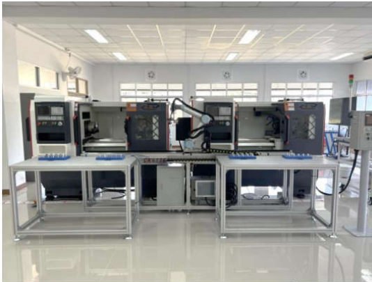
เครื่อง CNC และชุดแขนกลอัตโนมัติ
