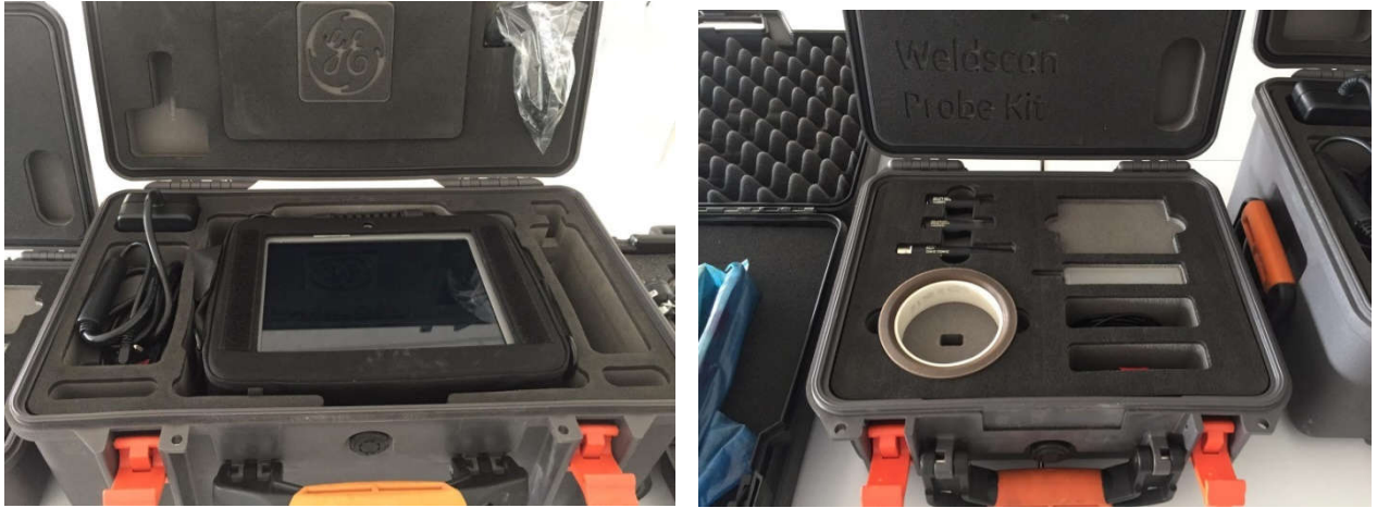
อุปกรณ์ทดสอบกระแสไหลวน (Eddy Current Test)
