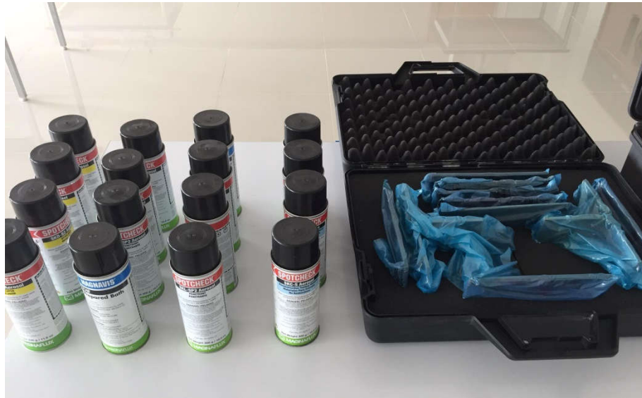
อุปกรณ์ทดสอบน้ำยาแทรกซึม (Penetration Test)
