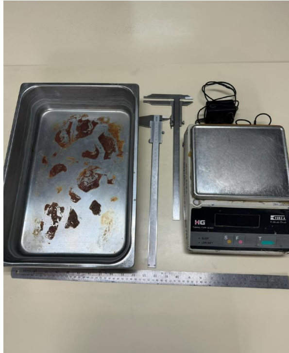
การทดสอบหาค่าการดูดซึมน้ำและความหนาแน่นของแผ่นใยไสร้อยต่อคอนกรีต
