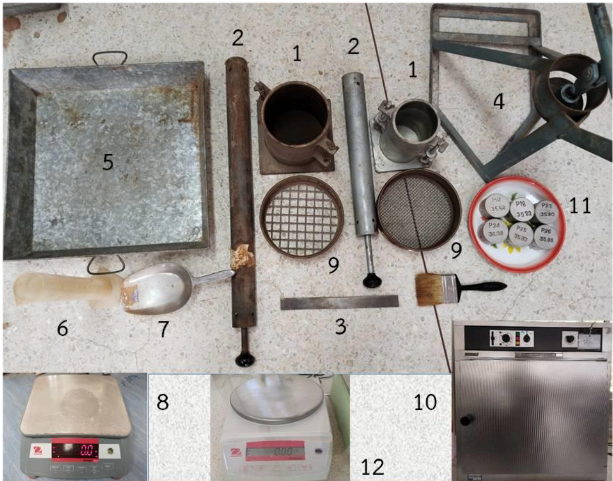
การทดสอบการบดอัดดิน (Compaction Test)
