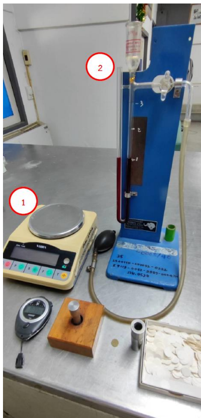
การทดสอบความละเอียดของปูนซีเมนต์โดยวิธีของเบลน
