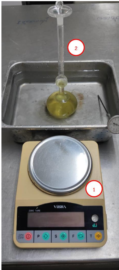
การทดสอบความถ่วงจำเพาะของปูนซีเมนต์
