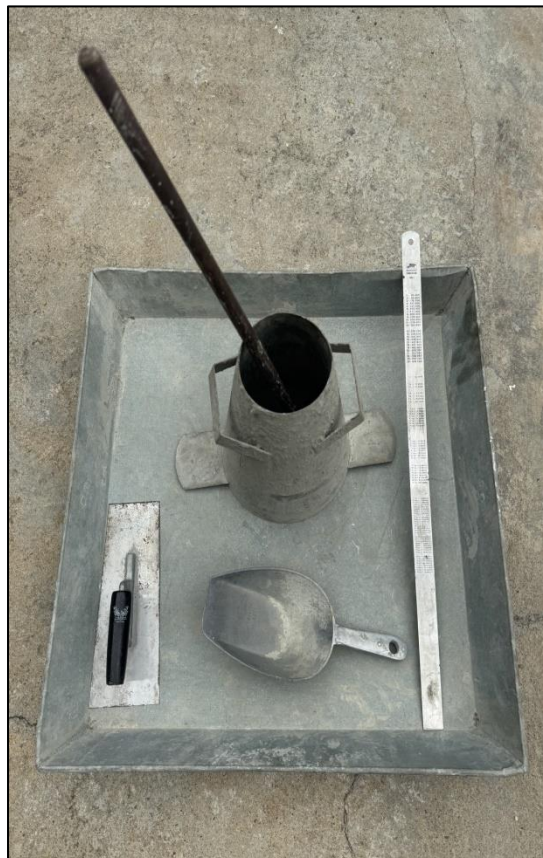
การทดสอบความข้นเหลวของคอนกรีต โดยการหาค่าความยุบตัว (Slump Test) ASTM C 143
