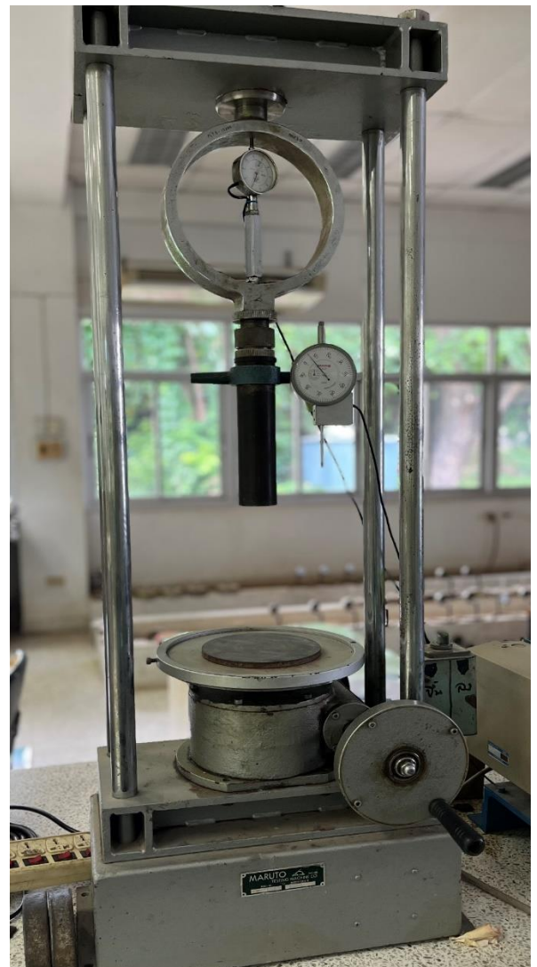
การทดสอบหาค่า CBR. (California Bearing Ratio Test)
